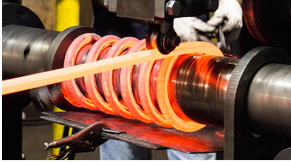
Şekil 3.34. Sıcak yay sarma prosesi
