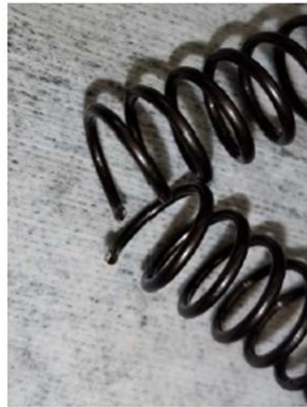
Şekil 3.27. Yorulma testi sonucu kırılan yay
