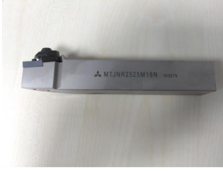
Şekil 3.11. Mitsubishi marka MTJNR2525M16N kodlu 93^\circ yanaşma açılı takım tutucu 93^\circ yanaşma açısına sahip takım tutucu TNMG 16 04 08-PF 4205 kodlu kesici uç kullanımına uygun olarak seçilmiştir.
