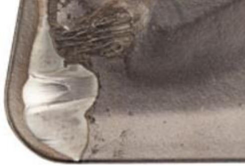
Şekil 2.21. Krater aşınması (Anonim 1990b)
