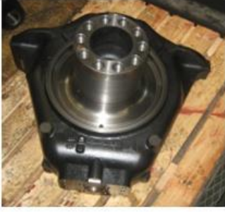
Şekil 2.15. SSF malzeme ile dökülmüş traktör aksunu
