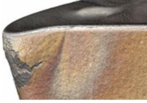
Şekil 2.24. Plastik deformasyon (Anonim 1990b)
