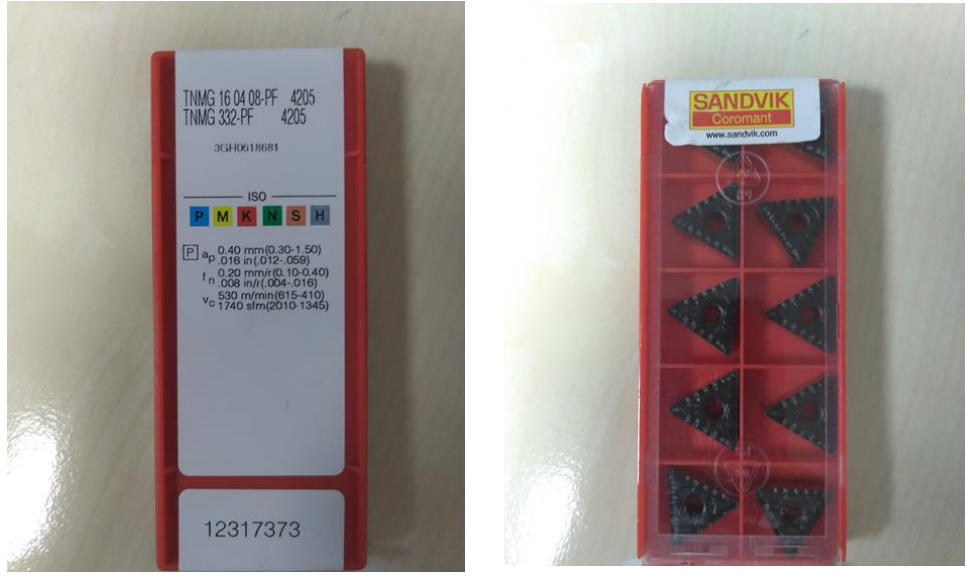
Şekil 3.8. TNMG 16 04 08-PF 4205 karbür kesici uç
