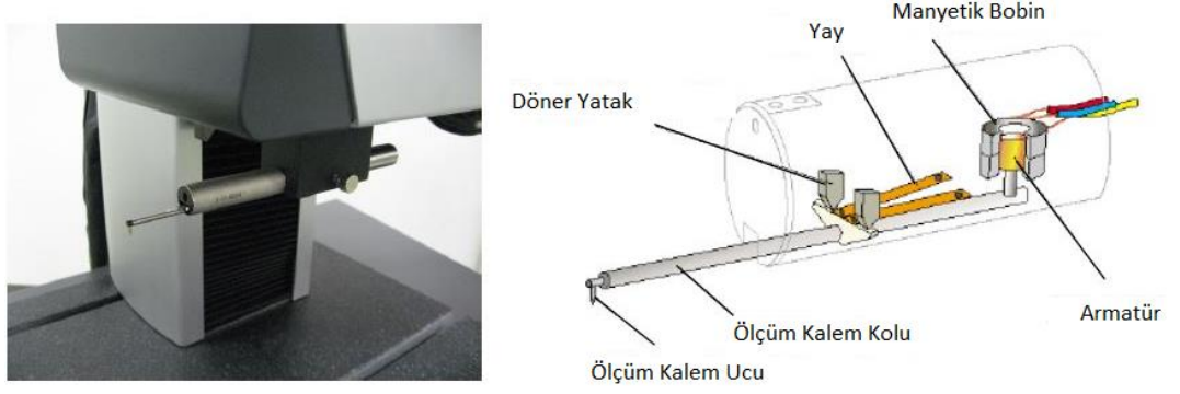
Şekil 2.17. Yüzey pürüzlülük cihazı ve iç yapısı
