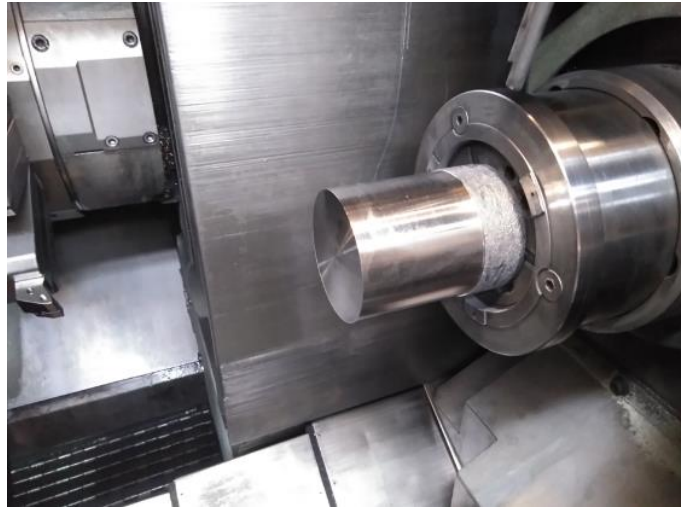
Şekil 3.4. Deney numunesinin aynaya bağlı hali.
