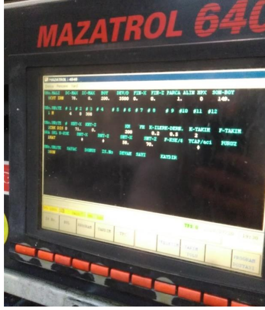
Şekil 3.6. Mazatrol 640T CNC torna tezgâhı program sayfası.
