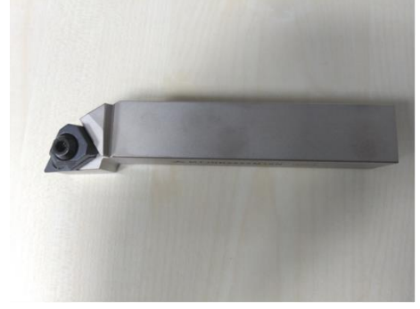
Şekil 3.11. Mitsubishi marka MTJNR2525M16N kodlu 93^\circ yanaşma açılı takım tutucu 93^\circ yanaşma açısına sahip takım tutucu TNMG 16 04 08-PF 4205 kodlu kesici uç kullanımına uygun olarak seçilmiştir.
