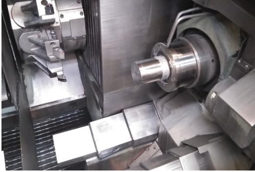
Şekil 3.21. İş parçasının tornalama öncesinde ve sonrasındaki hali
