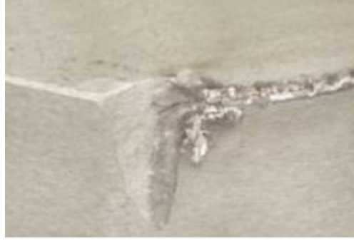
Şekil 2.23. Çentik aşınması (Anonim 1990b)
