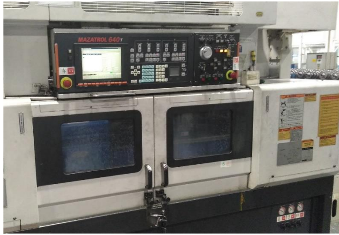
Şekil 3.5. Mazatrol 640T Cnc torna tezgâhı.
