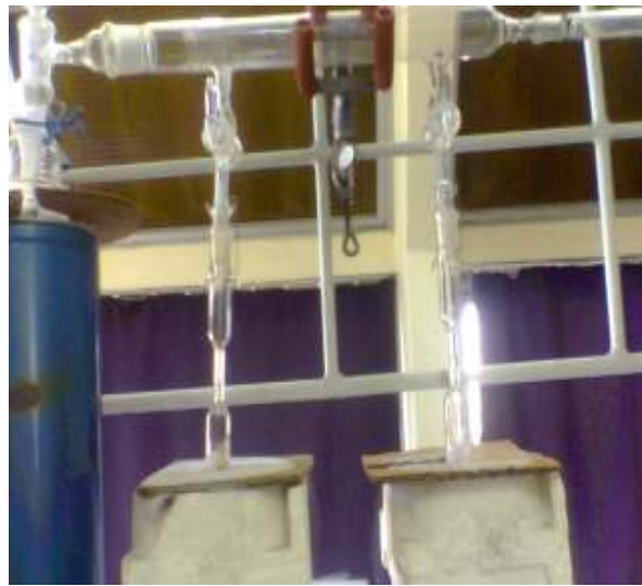
Şekil 2.14. Vakum sistemine bağlanmış iki adet örnek tüpü.
