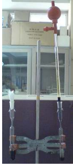
Şekil 2.18. Hazırlanan çözeltinin örnek tüpüne boşaltılması.
