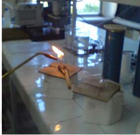
Şekil 2.20. Tüpün boğazı kesildikten sonra isli alev ile islenmesi.
