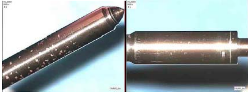
Şekil 7.9: İğne ucunda korozyon
