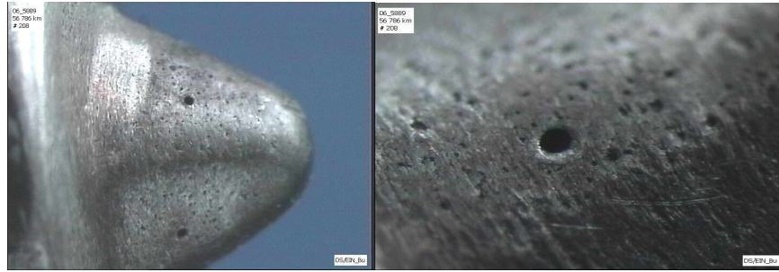
Şekil 7.5: Meme ucunda korozyon
