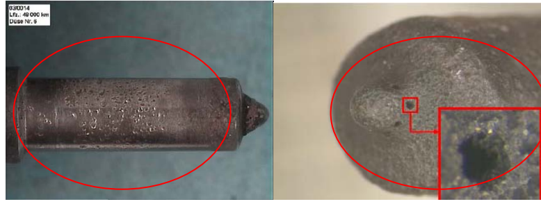
Şekil 7.4: Meme şaftında/püskürtme deliđi dış kısmında korozyon
