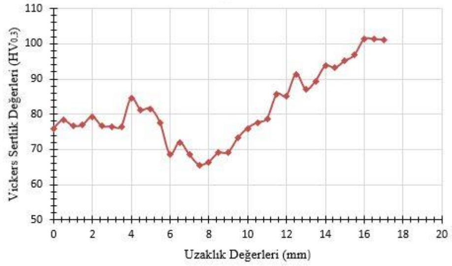
Şekil 4.14. D7 numunesinde pim boşluğundan uzaklıkla sertlik değeri değişimi
