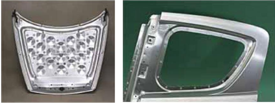
Şekil 1.3. Mazda tarafından SKNK yöntemi ile kaynak edilerek üretilmiş alüminyum motor kaputu ve arka kapılar (Kaluç ve Taban 2007)
