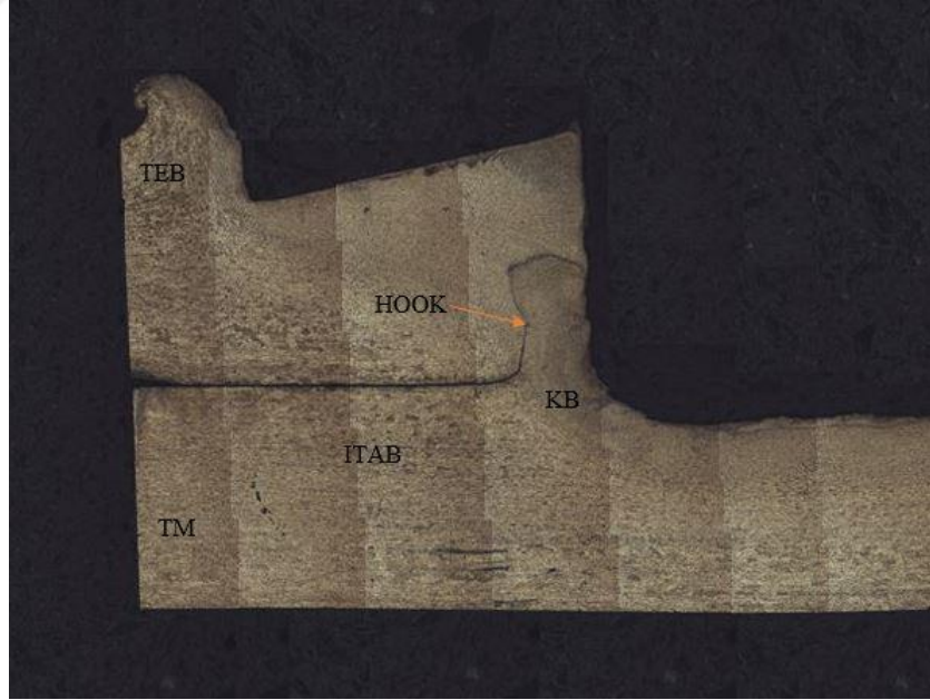
Şekil 4.1. Üretilen kaynakların makro yapı görüntüleri: (a) D1, (b) D4, (c) D5, (d) D7, (e) D8, (f) D2, (g) D11, (h) D14 (devam)
