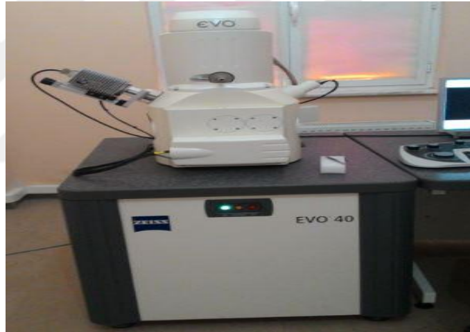
Şekil 3.4. Zeiss EVO 40 XVP marka taramalı elektron mikroskobu
