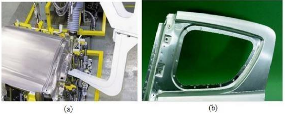
Şekil 2.5. Mazda RX-8'in gövde sacında ve kapı sacında kullanılan SKNK yöntemiyle yapılan birleştirmeler (a) SKNK yöntemiyle birleştirilen gövde paneli (b) RX8'in yan kapı panelindeki SKNK'lı bağlantılar (Hancock 2004)
