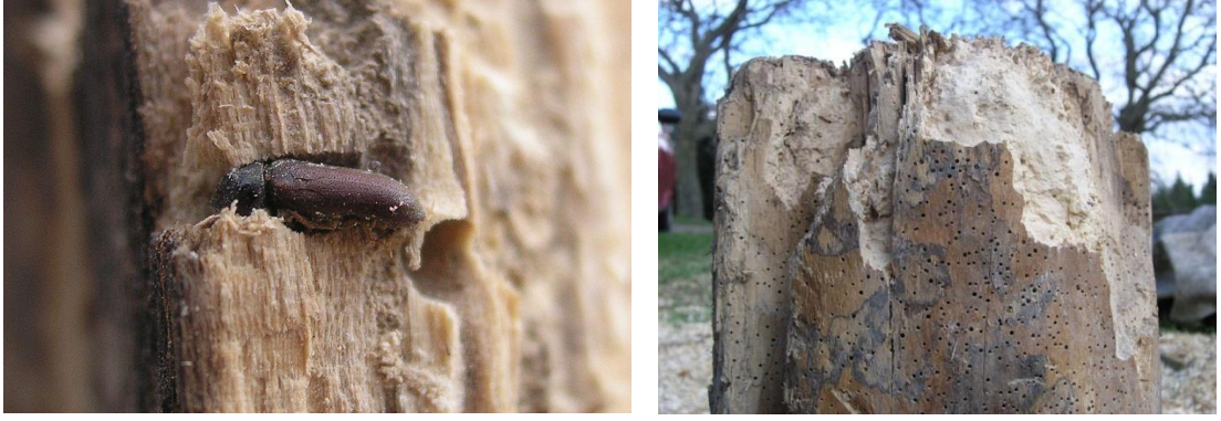
Şekil 4.4. Tahta kurtlarının ahşaba verdiği zararlar ( http://tr.wikipedia.org/wiki/Tahta_kurdu , 2013)
