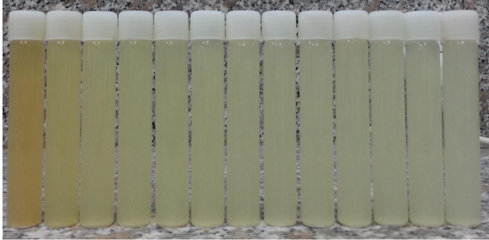
Şekil 4.16. Lacivert atık su 4'ncü ozonlama işleminden alınan su numuneleri
