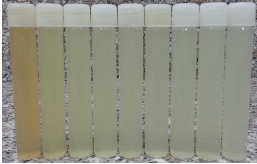
Şekil 4.11. Pembe atık su 3'ncü ozonlama işleminden alınan su numuneleri
