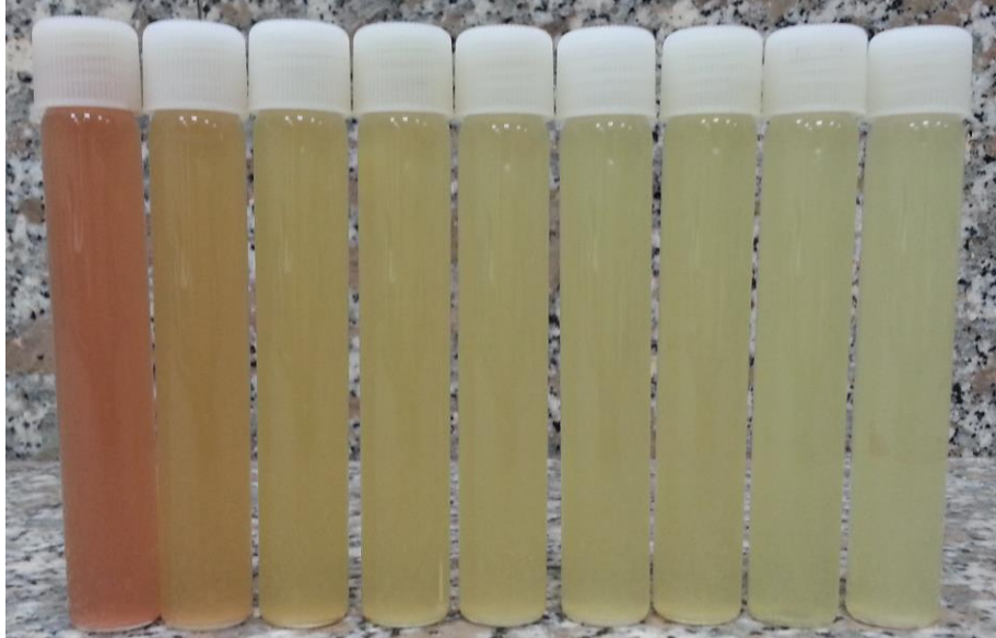
Şekil 4.9. Pembe atık su 1'nci ozonlama işleminden alınan su numuneleri
