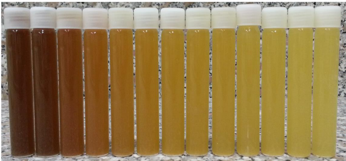
Şekil 4.13. Lacivert atık su 1'nci ozonlama işleminden alınan su numuneleri
