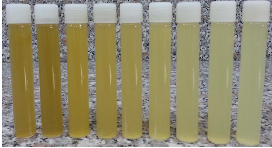
Şekil 4.2. Sarı neon atık su 2'nci ozonlama işleminden alınan su numuneleri
