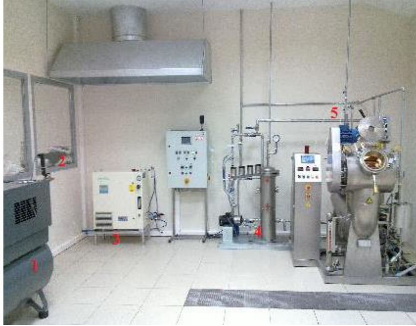
Şekil 3.1. Deney sistemi (1. Kompresör, 2. Desikant kurutucu, 3. Ozon jeneratörü, 4. Kontakt tank, 5. 5 kg'lık Jet boyama makinesi)
