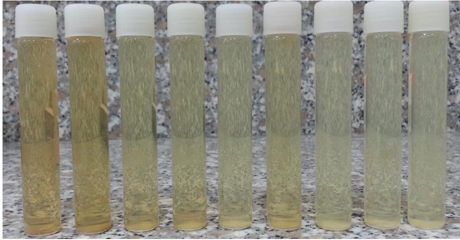
Şekil 4.3. Sarı neon atıksu 3'ncü ozonlama işleminden alınan su numuneleri
