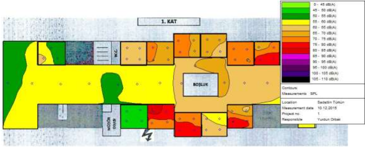
1. Kat Ders Sırasında Gürültü Durumu
