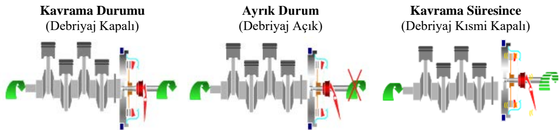
Şekil 3.13. Debriyaj sisteminin farklı koşullardaki tork iletimi
