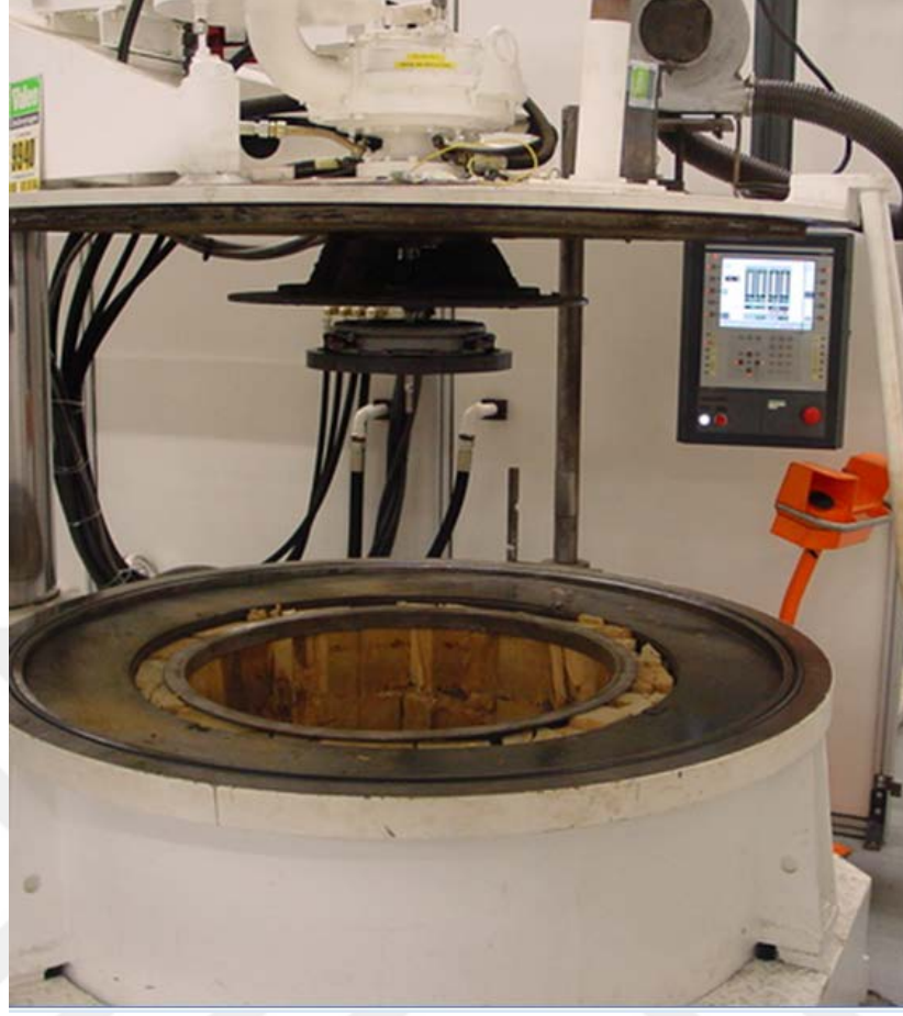
Şekil 3.31. Tezgah test düzeneği (patlama testi)
