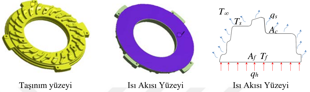
Şekil 3.37. Üç boyutlu analizlerdeki sınır şartları (Ansys Workbench)
