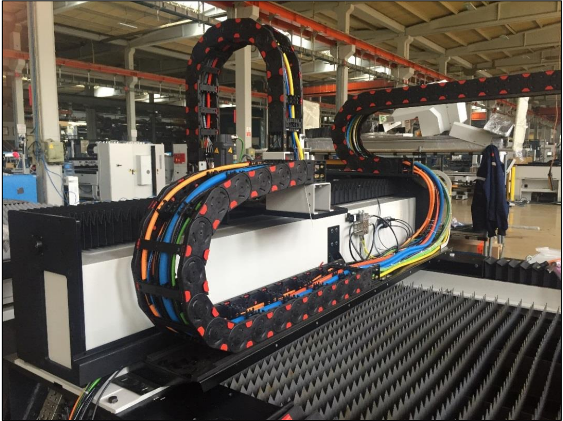
Şekil 4.40. Kompozit Y-eksenin makedeki montajı
