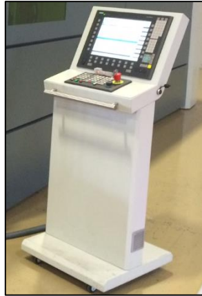
Şekil 3.10. Lazer kontrol ünitesi (Durma marka)
