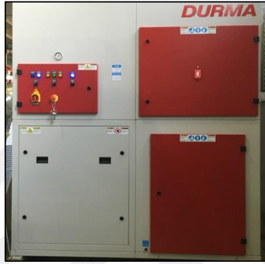
Şekil 3.7. Lazer toz toplama ünitesi (Vanterm Filtre)
