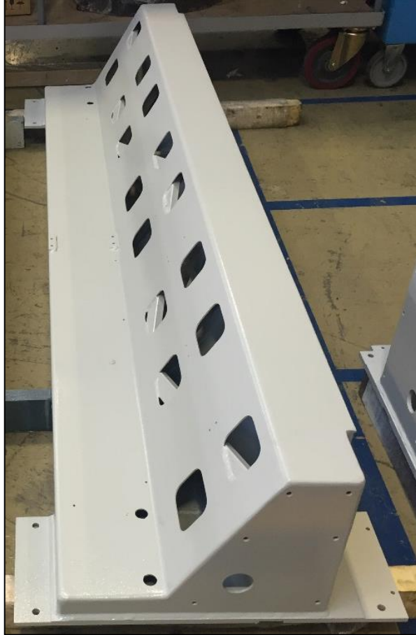
Şekil 3.13. Mevcut durumda lazer kesim tezgâhının Y-eksen köprüsü
