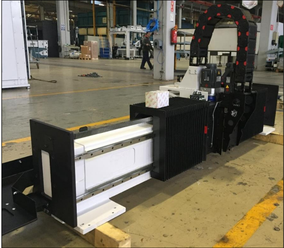
Şekil 3.12. Montajı tamamlanmış kompozit Y-eksen
