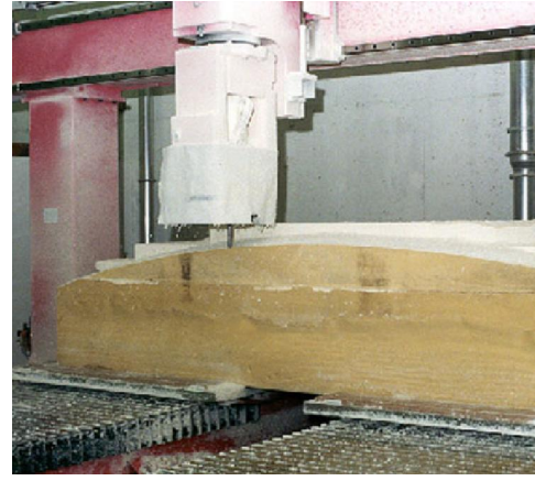
Şekil 4.30. Bubble BMW Sergi Salonu, B. Franken, Frankfurt, 1999. CAM yazılımlarından çıkan kodların CNC makinalarda kalıp yüzeylerinin oluşturulmasında kullanımı gösterilmektedir ( http://www.itaproject.eu/TTU/6/bubble.html ).
