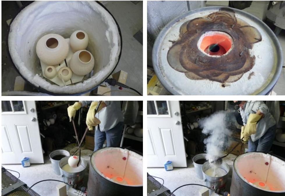
Fotoğraf 15. Obvara pişirim tekniği aşamaları
