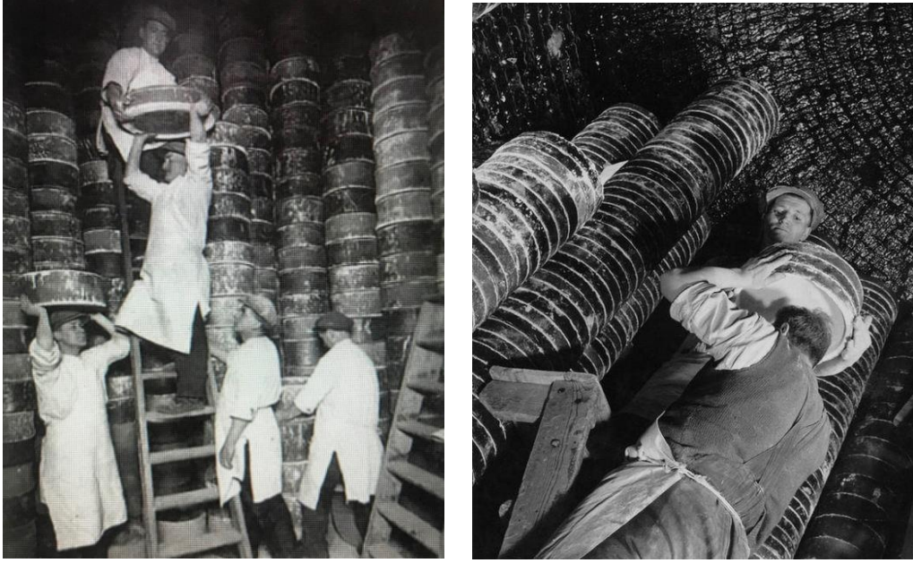
Fotoğraf 13. Sagar kutularının fırına istiflenmesi Kaynak: museumofroyalworchester.org
