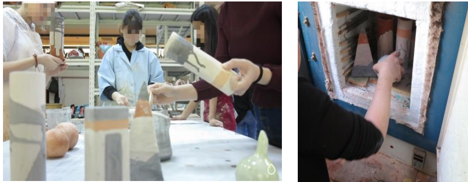
Fotoğraf 38. Seramik objelerin hazırlanması ve fırına yerleştirilmesi
