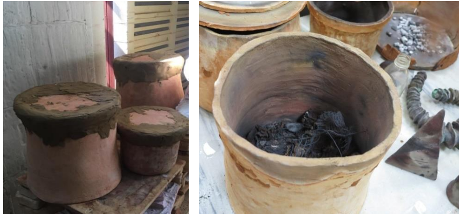
Fotoğraf 35. Fırınlama ve kutuların boşaltılması.
