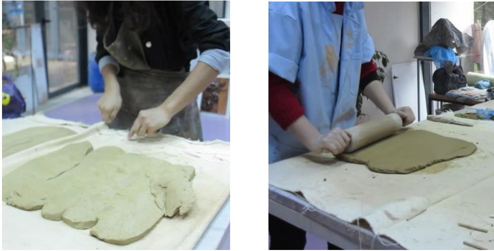
Fotoğraf 19. Çamur hazırlama ve plaka açma
