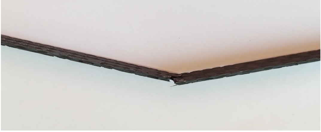
Şekil 4.3. Üç nokta eğilme testi sonrasında kompozit malzemede meydana gelen hasar
