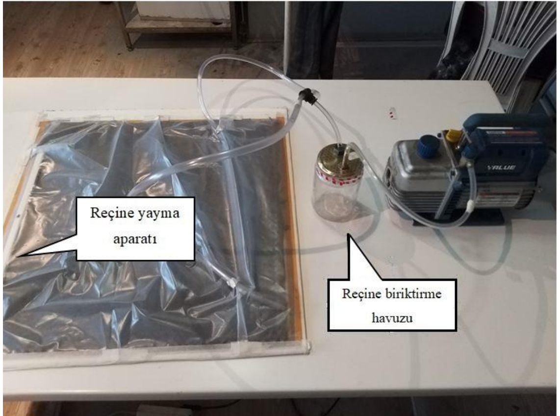
Şekil 3.2. İkinci denemeye ait vakum öncesi vakum torbalama sistemi
