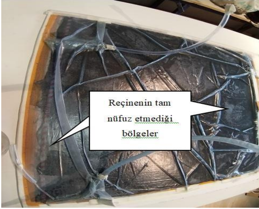
Şekil 3.3. İkinci denemeye ait reçine uygulaması sonrası vakum torbalama sistemi
