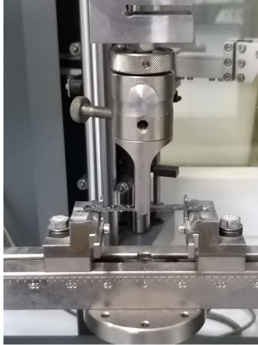
Şekil 3.6. Üç nokta eğilme test düzeneği
