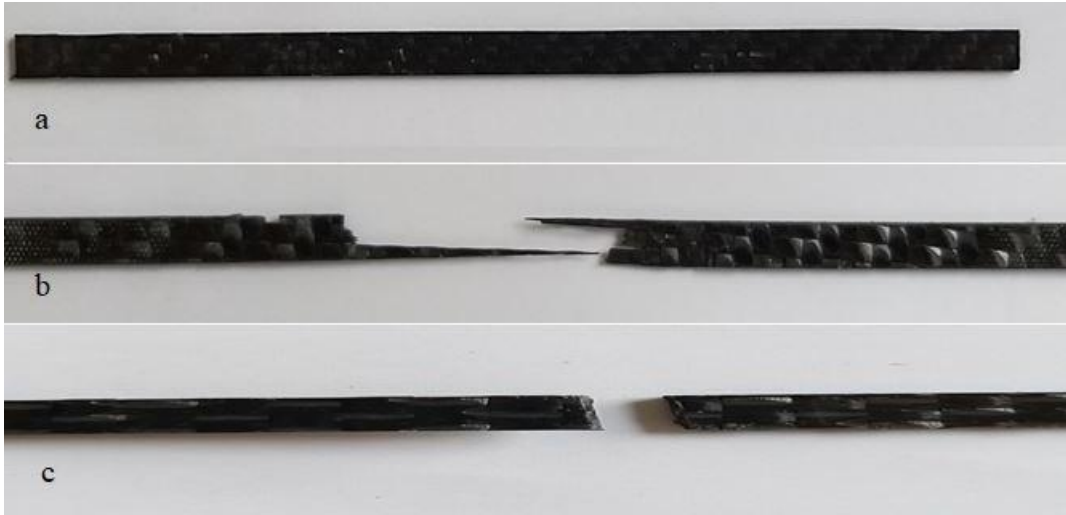
Şekil 4.1. Çekme testi öncesi deney numunesi, b) çekme testi sonrasında saçaklı kırılan kompozit numune, c) çekme testi sonrasında düz kırılan kompozit numune
