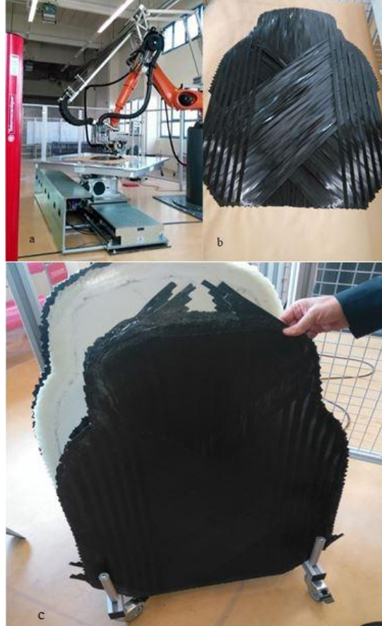
Şekil 1.6. a) Otomatik bant serme makinası, b) ATP ile serilmiş karbon bant şeritleri, c) pres ile şekillendirme sonrası elde edilen araç koltuğu arkası mamul kompozit malzeme
