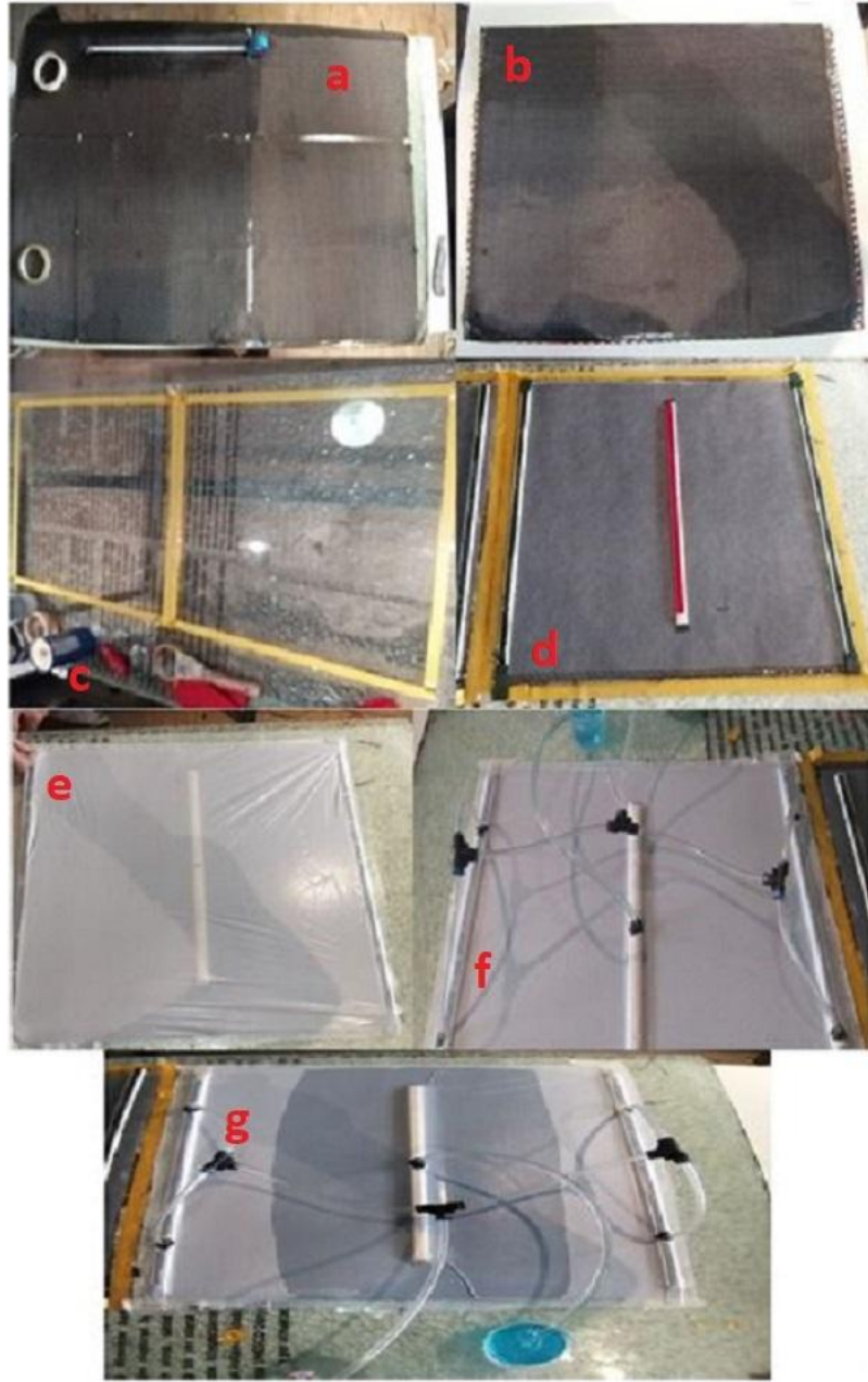
Şekil 3.4. Kompozit plakaların üretim aşamalarına ait resimler
