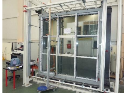
Şekil 2.6. Giydirme cephe hava geçirgenlik testi (Kişisel arşiv 2019).
