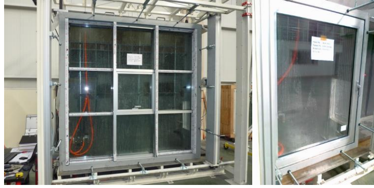
Şekil 2.7. Giydirme cephe su geçirimsizlik testi (Kişisel arşiv 2019).
