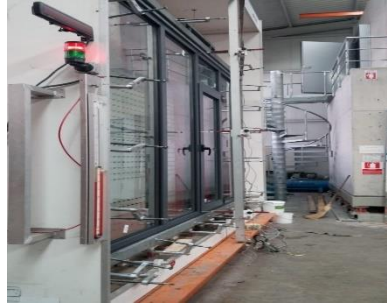
Şekil 2.9. Rüzgâr dayanım testi doğrama uygulaması (Kişisel arşiv 2019).
