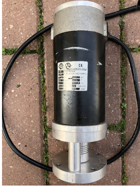
Şekil 3.5. Sistemde elektrik jeneratörü olarak kullanılacak DC motor
