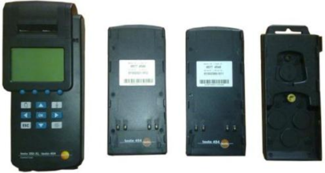
Şekil 3.18. Kontrol ünitesi (Kontrol cihazı, iki adet veri kayıt cihazı ve bağlantı parçası)
