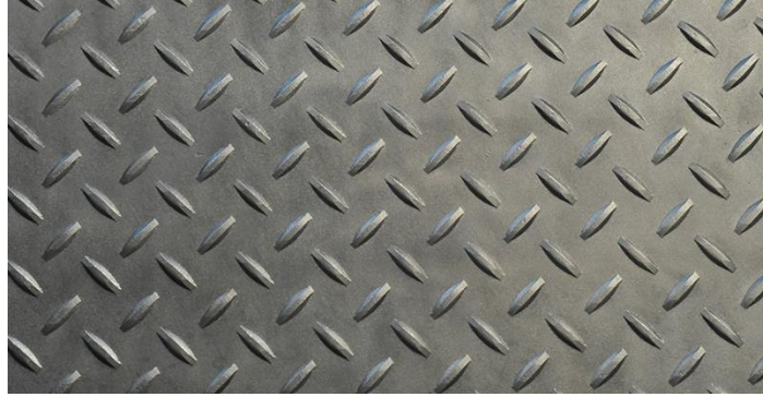
Őekil 2.5. Paslanmaz zemin plaka (Anonim 2016)
