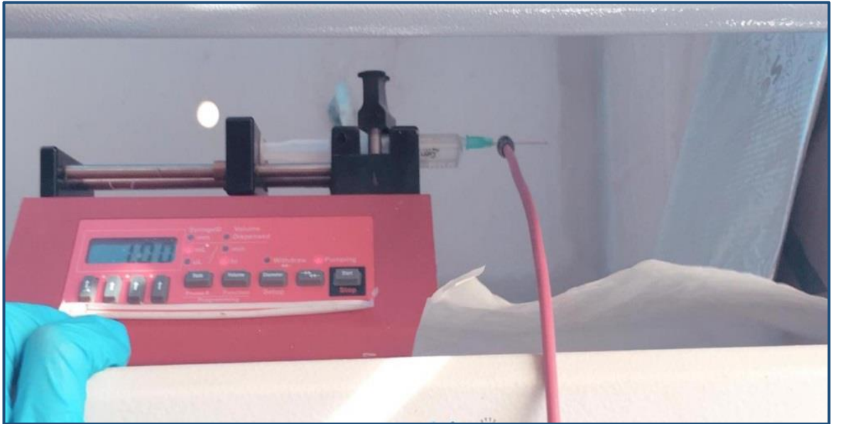
Şekil 3.2. PVC/ÇN nanoliflerin elektro çekim ünitesiyle üretiminin gösterimi.
