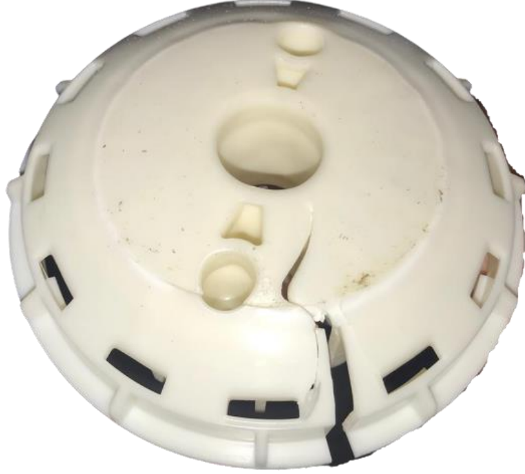
Şekil.4.5. Darbe testi sonucu kırılmış olan numune
