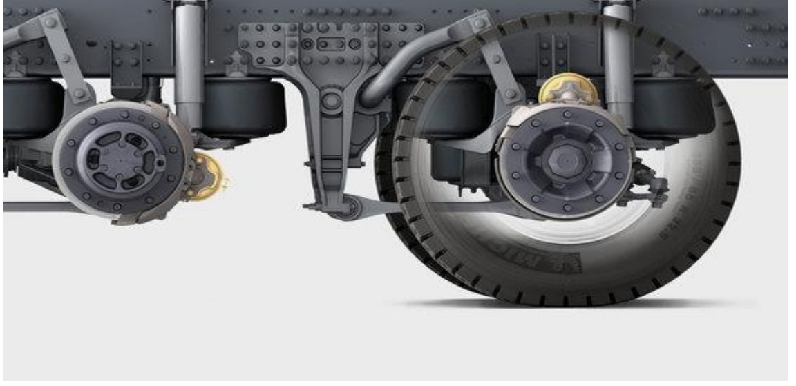
Şekil 2.1. Hava süspansiyon körüklerinin çekiciye monte edilmiş hali (Anonim 2020a).
