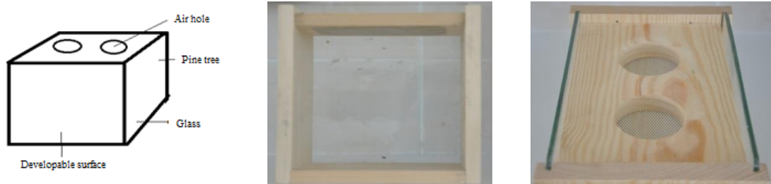
Şekil 3.8. Numunelerin arı kovuculuk özelliklerinin analiz edildiği ölçüm kabinleri
