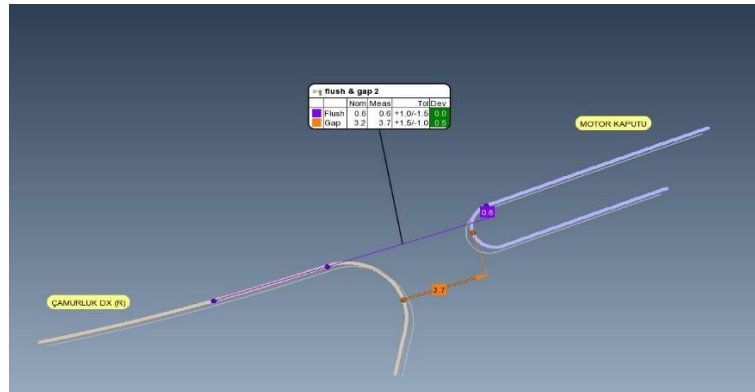
Şekil 3. 21. Kesitte sanal nokta bulutu ile flush & gap stratejisiyle ölçülen bir nokta
