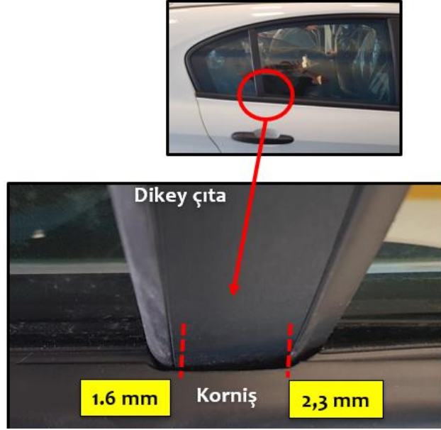
Şekil 4. 17. Dikey çita ve korniş aralık ilişkisi
