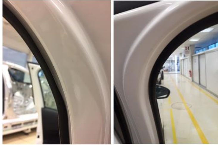
Şekil 4. 11. A- geçmişten hata oluşmuş bir arka kapı, B- hatasız bir arka kapı
