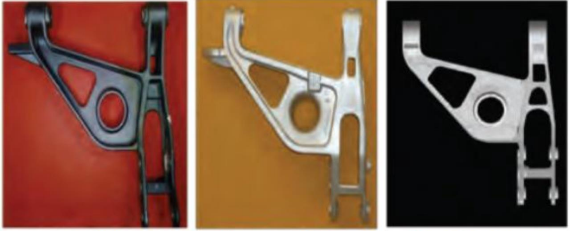
Çelik malzeme kullanılmış tasarım 7,5 kg
