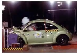
Şekil 2.15. Düz duvara çarpma testinde taşıtın 3 farklı neslinin davranışı (Anonim 2020)
