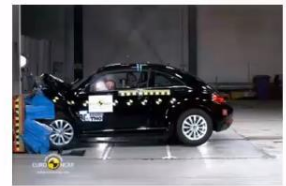
Şekil 2.15. Düz duvara çarpma testinde taşıtın 3 farklı neslinin davranışı (Anonim 2020)
