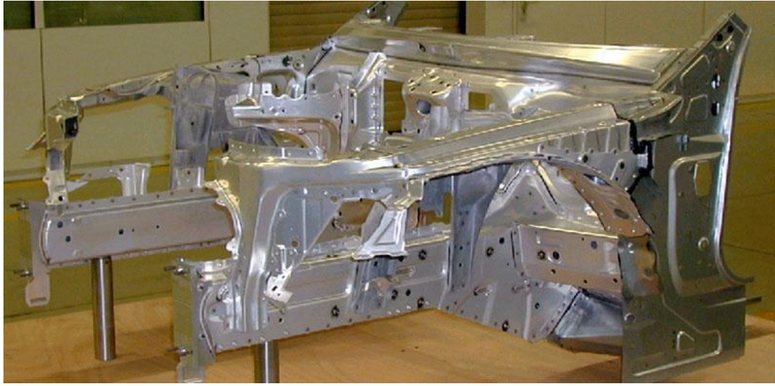
Şekil 2.17. Audi A3 levhadan üretilmiş ön bölümü (Dündar ve Güngör 2002)
