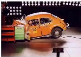
Şekil 2.15. Düz duvara çarpma testinde taşıtın 3 farklı neslinin davranışı (Anonim 2020)
