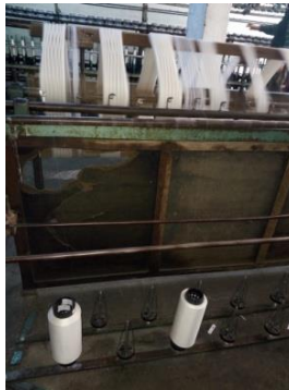
Şekil 3.16. Bükümlü ham ipek ipliklerinin bobinden çileye aktarıldığı makine
