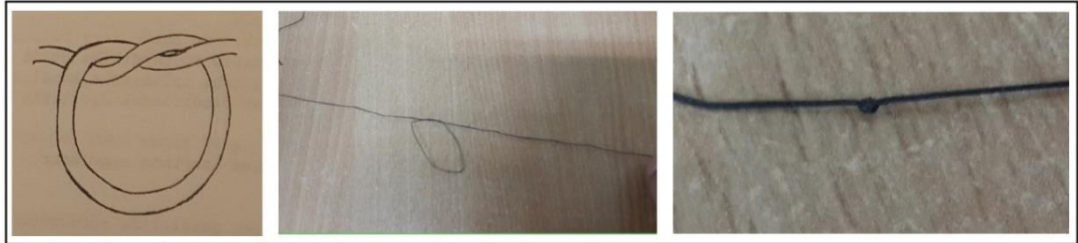
Şekil 3.43. Düğüm mukavemeti testi için ipliklerin ortasına atılan basit düğüm
