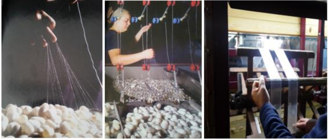
Şekil 2.6. Kozalardan uç bulma ve çekim işlemi (Çetin Akgün, 2008)
