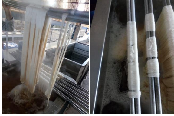
Şekil 3.28. Bükümlü ham ipek ipliklerinden serisin giderme işlemi
