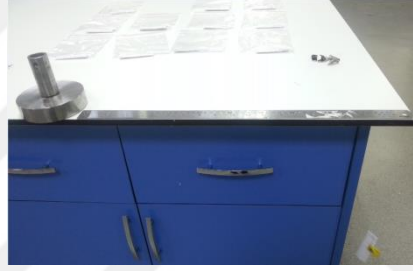
Şekil 3.42. Gerginlik altında iplik uzunluğunun ölçümü
