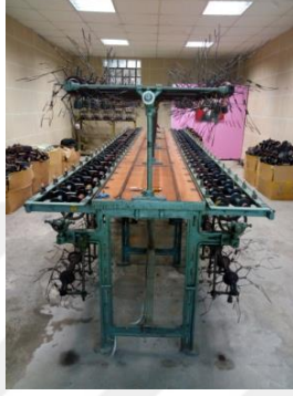
Şekil 3.14. Ham ipek filamentlerinin çileden makaraya aktarıldığı makine
