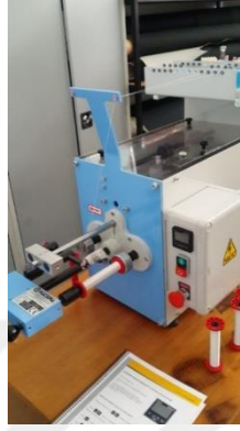
Şekil 3.32. Kılıf iplik bobinlerinin hazırlanması
