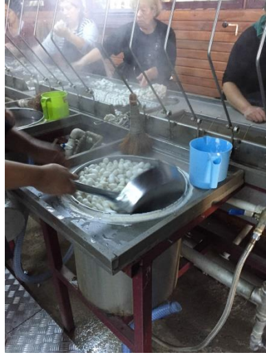
Şekil 2.5. Koza kaynatma işlemi (Ünal İpek- Bursa)
