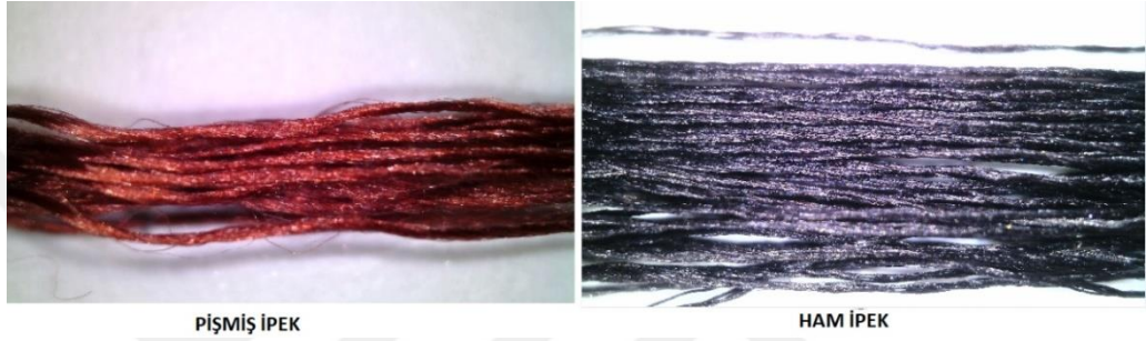
Şekil 4.20. Neocarmin W ile boyanmış ham ve pişmiş ipek ipliklerinin mikroskop görüntüleri
