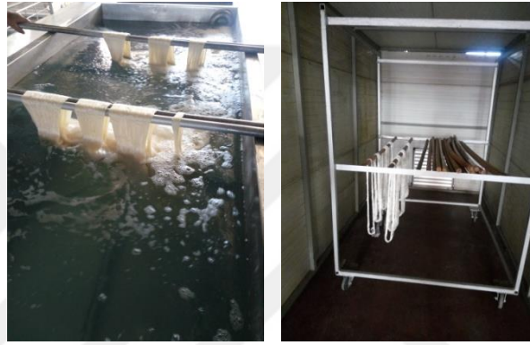
Şekil 3.29. Serisin giderme sonrası yıkama ve kurutma işlemi
