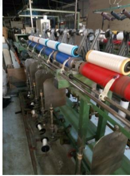
Şekil 3.15. Ham ipek filamentlerinin makaradan bobine aktarıldığı makine
