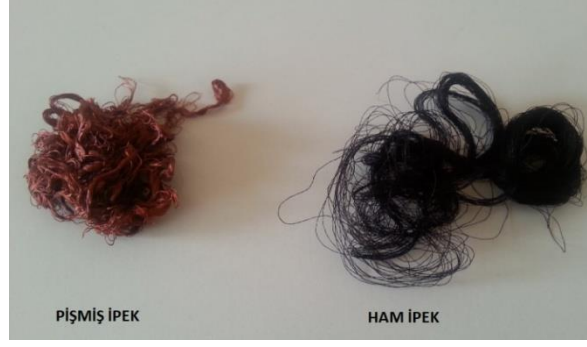
Şekil 4.19. Neocarmin W ile boyanmış ham ve pişmiş ipek iplikleri
