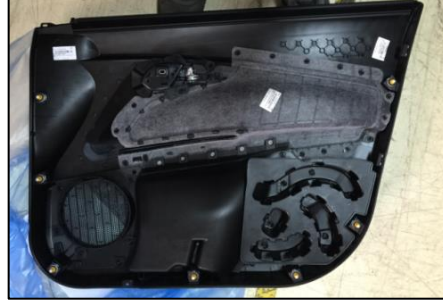
Şekil 5.5. Seri imalatta kullanılan yeni nesil PP malzeme yandan çarpışma sönümleyici
