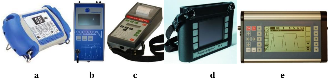
Şekil 1.1. Süt sağım tesisi testlerinde kullanılan bazı vakum-nabız kayıt cihazları (a-VPR100; b-Vacuscope; c-PT IV; d-PT V; e-Pulsotest Comfort (V 1.2))
