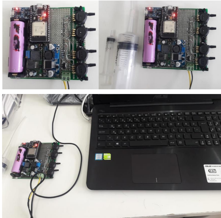
Şekil 4.2. Prototip vakum-nabız kayıt cihazı ve deney işlemi
