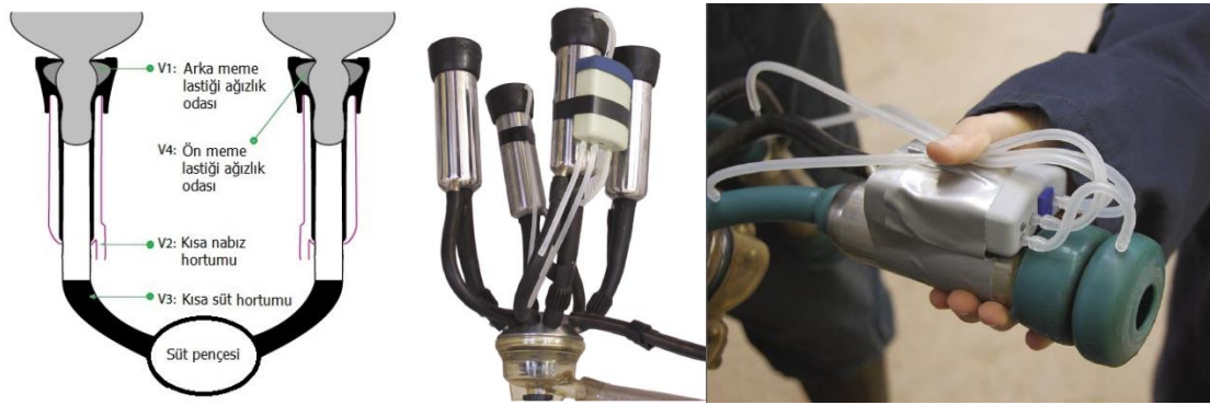
Şekil 2.1. Vakum-nabız kayıt cihazının sağım başlığındaki ölçüm noktaları ve cihazın memeliğe bağlantısı
