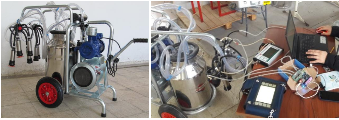
Şekil 3.3. Deney makinası ile Hayuka, Exendis ve Gea cihazlarının test aşaması
