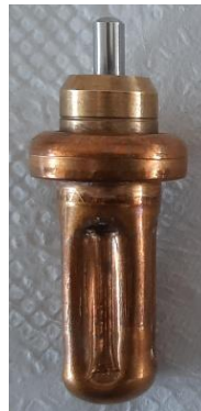
Şekil 3.8. Montaj edilmiş yıldız çanak ve parafin/vaks karışımı
