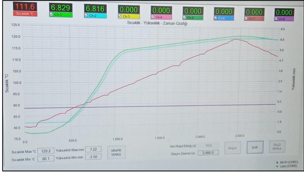
Şekil 4.7. Test sonunda termal eleman pistonunun ilerlemesini gösteren grafik
