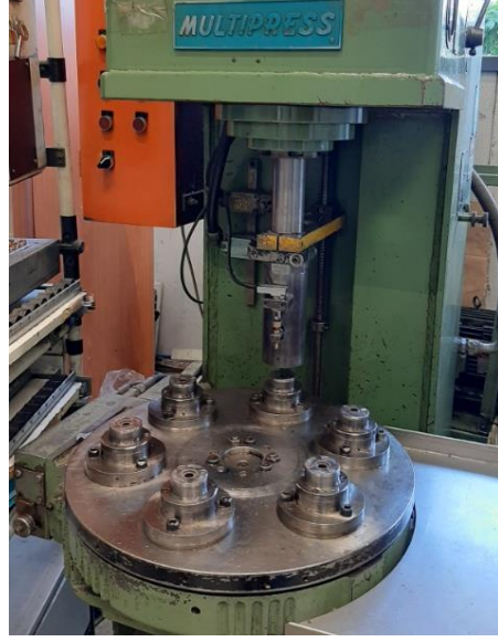
Şekil 3.9. Montaj için kullanılan 8 tonluk hidrolik pres
