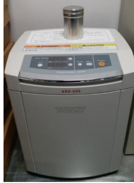
Şekil 3.1. ARE 250 marka santrifüj karıştırıcı
