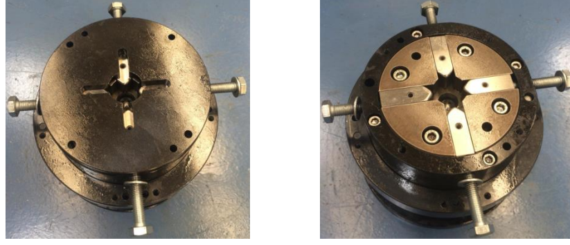
Şekil 3.6. Yıldız çanak prototip üretimi için üretilen kalıplar
