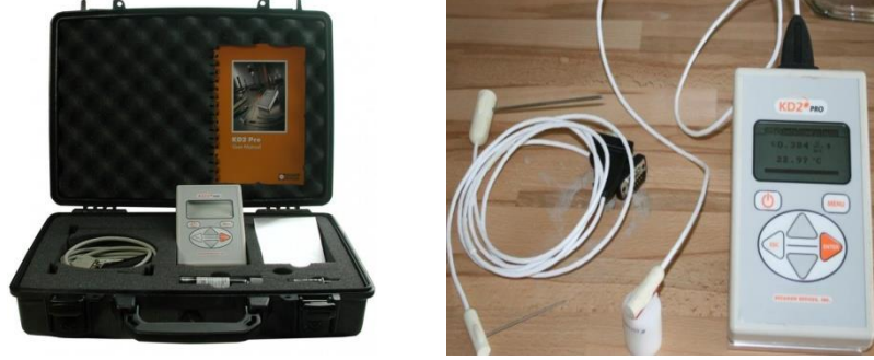
Şekil 3.2. Isıl iletim katsayısı ölçümünde kullanılan Decagon KD2 Pro marka ısıl iletkenlik ölçüm cihazı.
