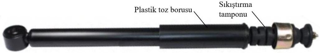
Şekil 3.17. Plastik toz borusu ve sıkıştırma tamponuna sahip amortisör örneği
