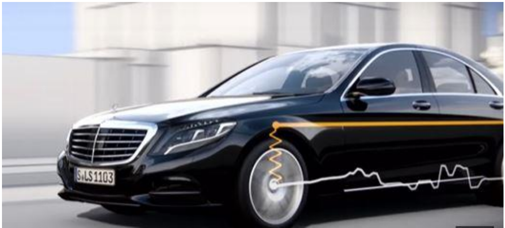
Şekil 2.5. Mercedes Benz aktif gövde kontrolü (Anonim, 2016)
