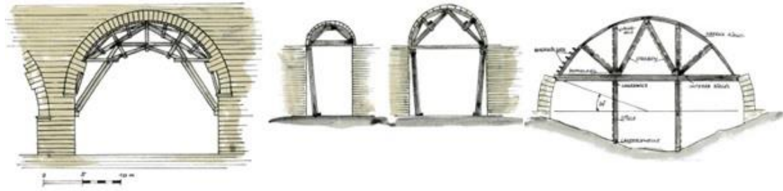
Şekil 3.41. Taşıyıcı iskele yapımı (Barow 2013)
