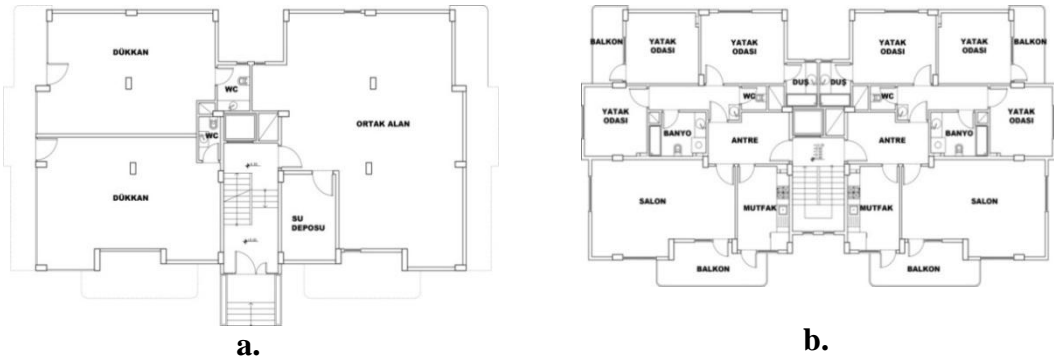
Şekil 4.7. a. Örnek 1 konut sitesinin kentsel dönüşüm öncesi bodrum kat planı (Nilüfer Belediyesi arşiv, 04.02.2019), b. Örnek 1 konut sitesinin kentsel dönüşüm öncesi normal kat planı (Nilüfer Belediyesi arşiv, 04.02.2019)
