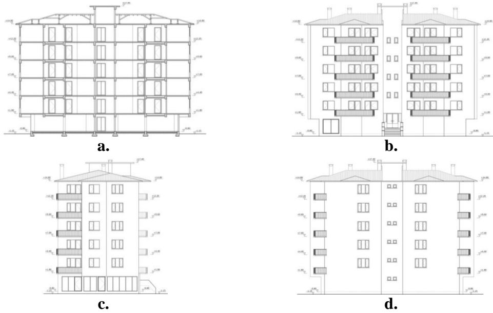
Şekil 4.8. a. Örnek 1 konut sitesinin kentsel dönüşüm öncesi kesiti (Nilüfer Belediyesi arşiv, 04.02.2019), b. Örnek 1 konut sitesinin kentsel dönüşüm öncesi ön cephesi (Nilüfer Belediyesi arşiv, 04.02.2019), c. Örnek 1 konut sitesinin kentsel dönüşüm öncesi yan cephesi (Nilüfer Belediyesi arşiv, 04.02.2019), d. Örnek 1 konut sitesinin kentsel dönüşüm öncesi arka cephesi (Nilüfer Belediyesi arşiv, 04.02.2019)
