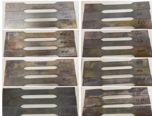
Şekil 3.3. Çekme özelliklerindeki değişimin incelenmesi için hazırlanan çekme testi deney numuneleri
