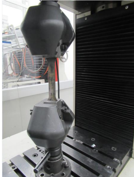
Şekil 3.9. SHIMADZU AG-I model çekme cihazında numunenin test öncesi görünümü
