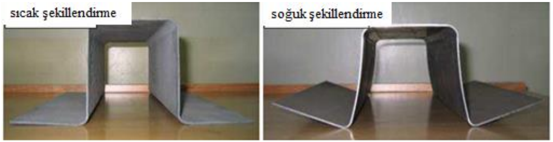
Şekil 2.22. Ultra yüksek dayanımlı çeliğin sıcak şekillendirme ve soğuk şekillendirme sonrası görünümü (Yao ve ark. 2013)
