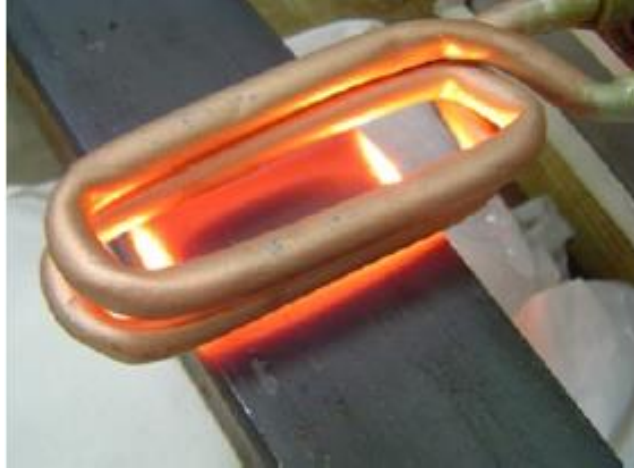
Şekil 2.15. İndüksiyonla ısıtma yöntemi kullanılarak ısıtılan parça örneği (Ece ve Öztürk 2010)
