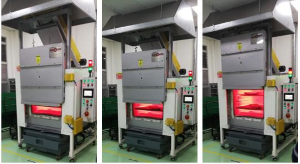
Şekil 3.7. Deneysel çalışmalarda kullanılan Teknik Isısan Rezistans Sanayi ve Ticaret LTD. ŞTİ. tarafından temin edilen 30 kW gücündeki ısıl işlem fırını
