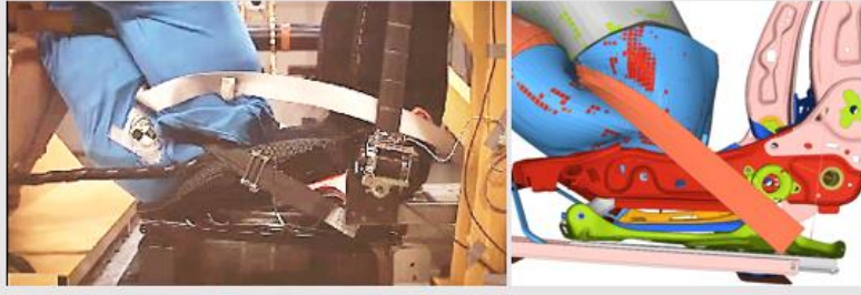
ekil 4.15. ECE R17 önden çarpma test ve sonlu eleman sonuçları, n, n k, yaşlaması,
