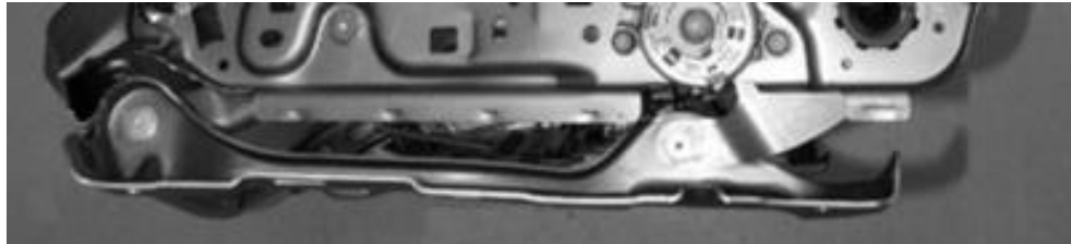
ekil 4.10. ECE R17 önden çarpma test sonrası, k,zak braketi yan görünüşü
