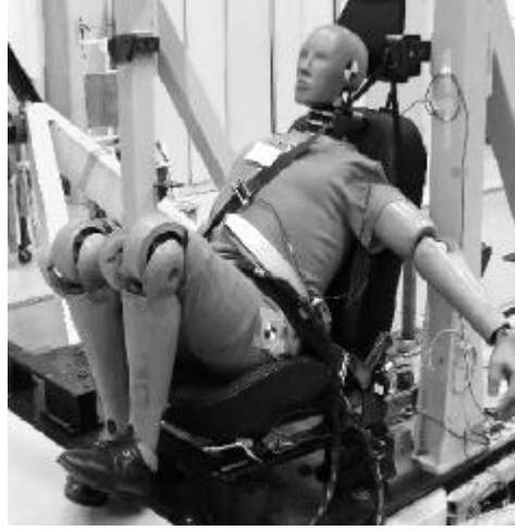
ekil 4.8. ECE R17 önden çarpma test sonrası, perspektif görünüşü
