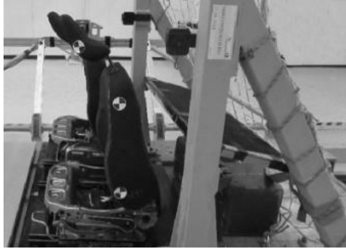
ekil 4.12. ECE R17 bagaj çarpma testi sonrasında, yan genel görünümü
