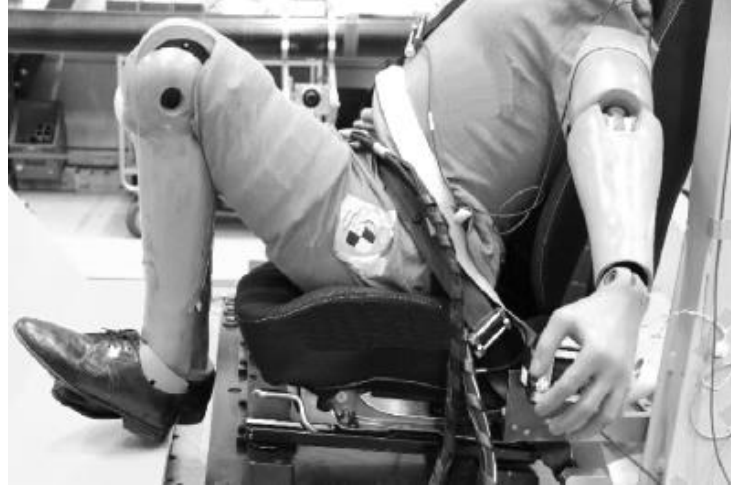
ekil 4.9. ECE R17 önden çarpma test sonrası, yan görünüşü
