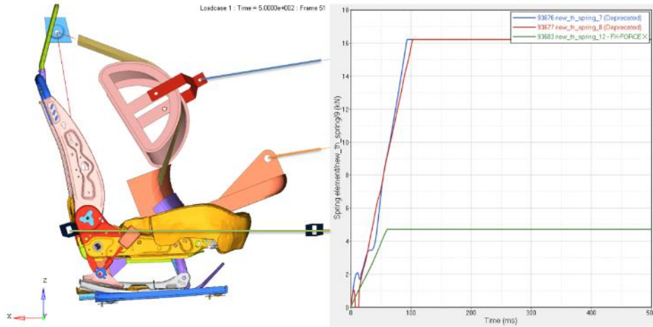
ekil 4.1. ECE R14 sonlu eleman analiz sonucu
