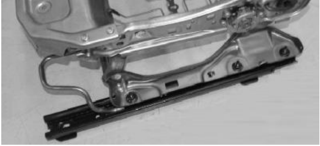
ekil 4.6. ECE R14 test sonrası, braket detay görünümü
