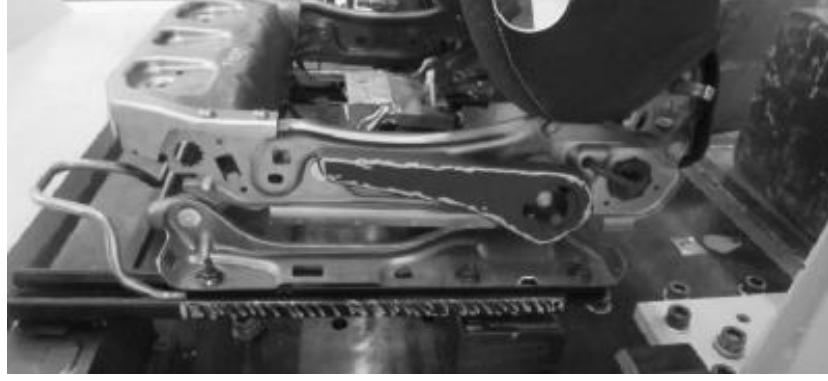
ekil 4.13. ECE R17 bagaj çarpma test sonras, yan görünü
