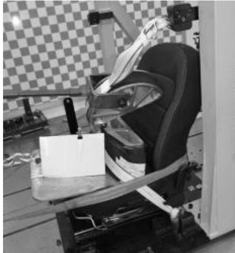
ekil 4.5. ECE R14 test sonrası, koltuk yan görünümü
