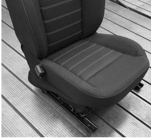
ekil 3.25. Prototip üretimi yapılan komple koltuk
