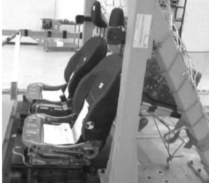
ekil 3.32. ECE R17 bagaj çarpma testi için test cihaz,na kurulmu koltuk
