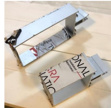
Şekil 2.46. Yatay (tranzom) profil örnek kesitleri (Asaş katalog, Anonim 2019zc)
