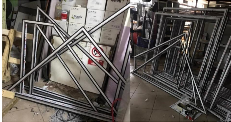
Şekil 2.70. Silikon cephe kaset imalat örnekleri (Anonim 2019).
