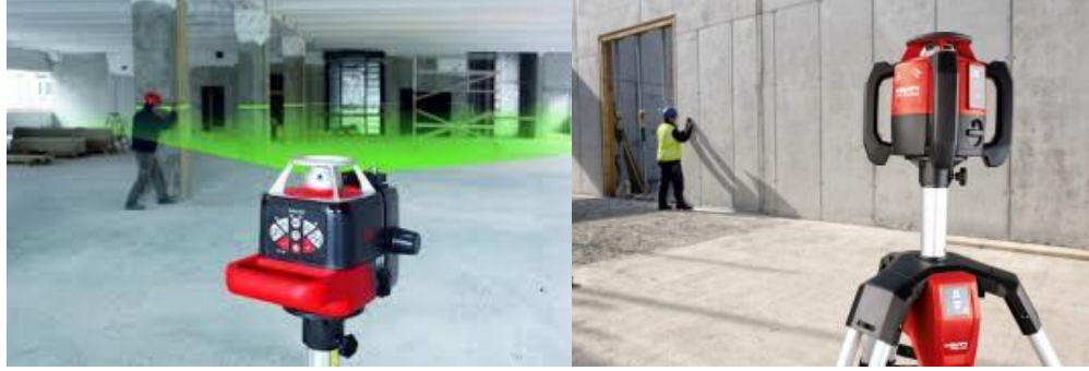
Şekil 2.63. Lazerli nivo örneği ve uygulama şekli (Anonim 2019)
