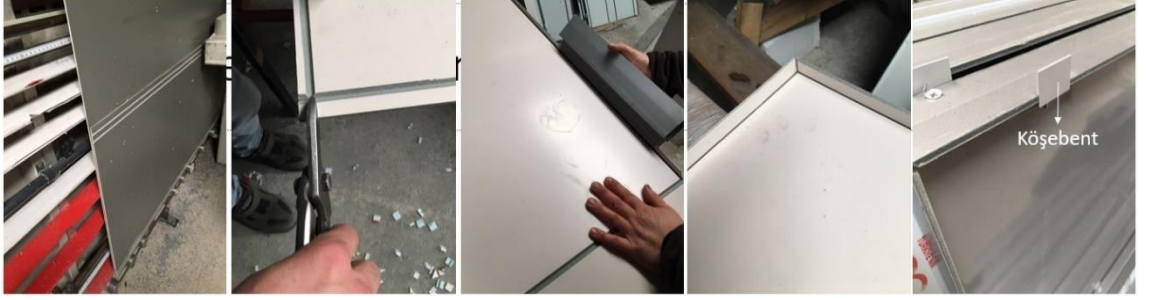
Şekil 2.71. Alüminyum kompozit panel imalatı (Anonim 2018).
