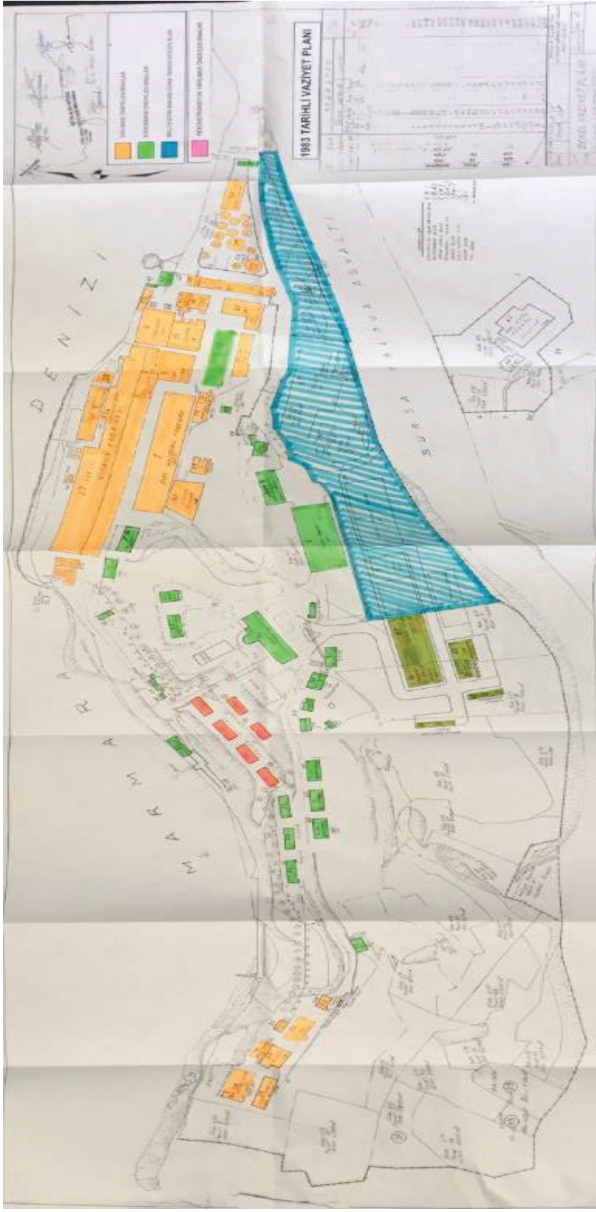
Şekil 2.41. 1983 tarihli vaziyet planında Milli Eğitim Bakanlığı'na tahsis edilen alan, korunması, yıkılması, Rekonstrüksiyon yapılması önerilen binalar (U.Ü. 2015)
