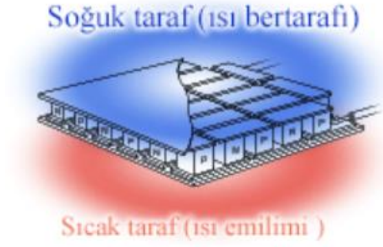
Şekil 3.6 Peltier elemanı çalışma mantığı (Bulut 2005)
