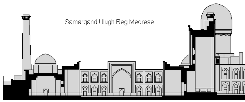
Şekil 3.6. Uluğ Bey Medresesi'nin kesiti (Anonim 2019d)
