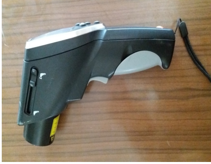
Şekil 3.10. Kızıl ötesi sıcaklık ölçer
