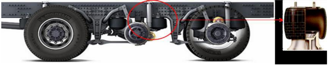
Şekil 2.4. Yük taşıtı üzerinde pnömatik bir yay (Çallı 2015)
