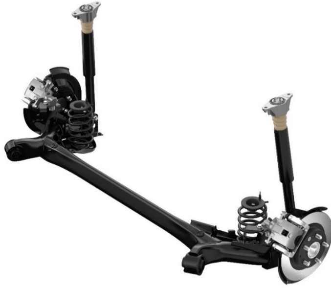
Şekil 2.13. Mazda 3 marka araca ait burulma kirişli arka aks süspansiyon sistemi (Anonim 2019i)
