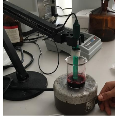
Şekil 3.17. Meyvede pH ölçümü (Orijinal foto: S. Poyraz Engin)
