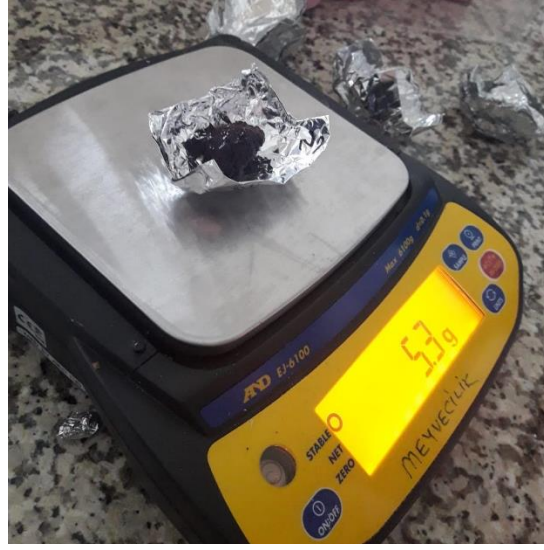
Şekil 3.19. Meyvede toplam kuru madde çalışması (Orijinal foto: S. Poyraz Engin)
