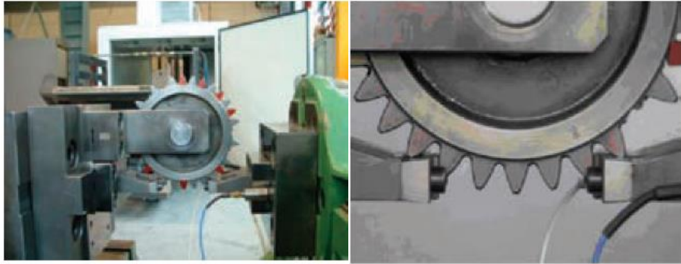
řekil 2.3. Literatürde kullanılan tek diř yorulma aparatı. Gasparini ve ark. (2009).
