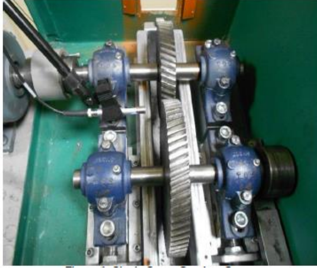
řekil 2.2. Akustik emisyon yönteminde kullanılan deney düzeneęi (Ulus ve Erkaya 2015).
