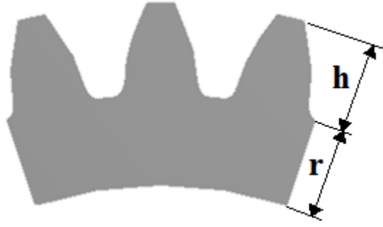
Şekil 3.20. Standart bir dişli üzerinde rim oranı
