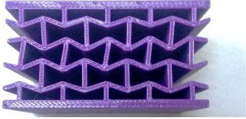
Şekil 4. 16. Deney sonrası altıgen balpeteği çekirdek geometrili sandviç yapıya ait numune ve hasar görüntüsü
