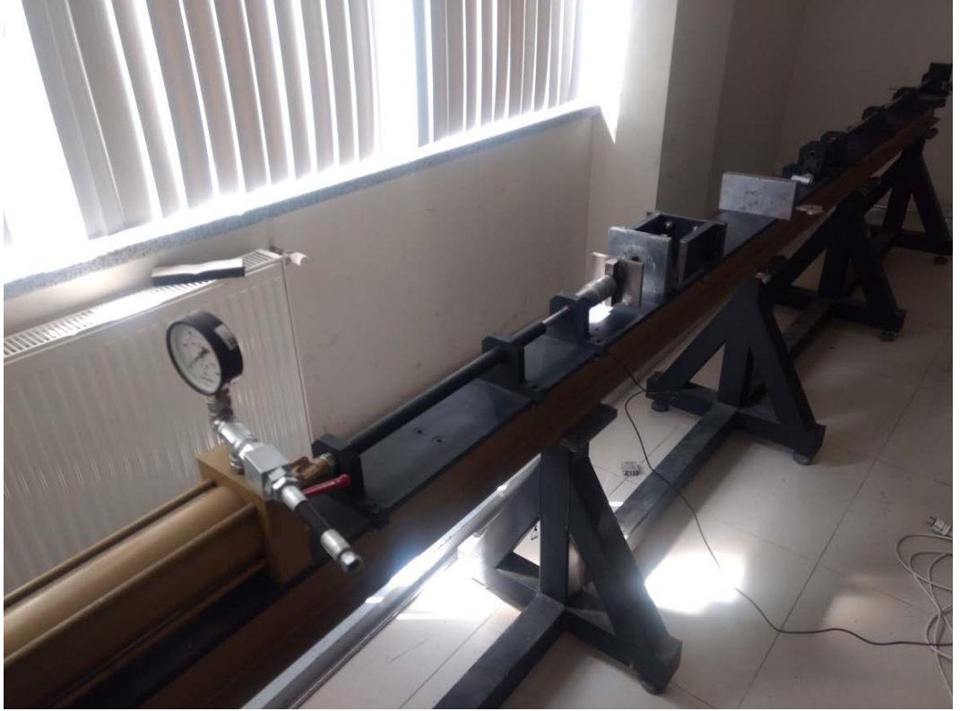
Şekil 3.44. SHB test düzeneğinden dönüştürülmüş dinamik bası test düzeneği
