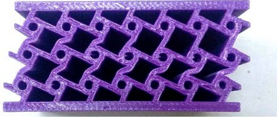
Şekil 4. 24. Deney sonrası tetrachiral çekirdek geometrili sandviç yapıya ait numune ve hasar görüntüsü
