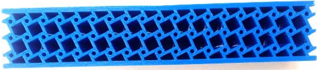
Şekil 4. 79. Tetrachiral çekirdek geometrisine sahip sandviç yapının dinamik 3-nokta eğilme deneyi sonu hasar görünümü
