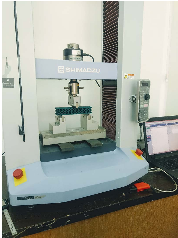
Şekil 3.42. 3-Nokta eğme deneyi gerçekleştirilen universal test cihazı
