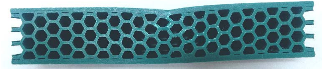
Şekil 4. 34. 3-Nokta eğme testi sonrası altıgen balpeteği çekirdeğe sahip sandviç yapıdaki hasar görünümü
