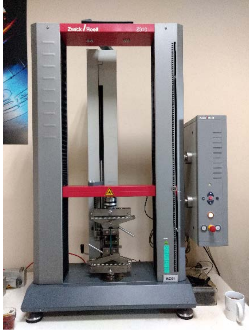
Şekil 3.40. Basma deneyinin gerçekleştirildiği universal test cihazı
