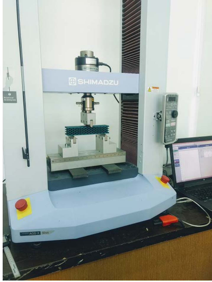
Şekil 4. 28. 3-Nokta eğme test düzeneği ve testten bir görüntü
