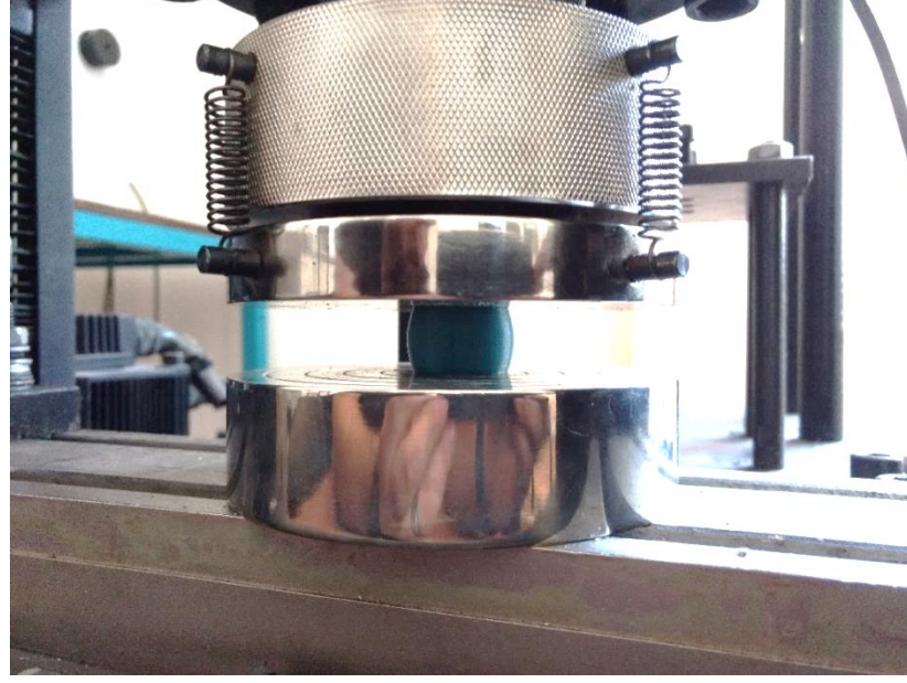
Şekil 4. 3. Numuneye uygulanan basma testi görüntüsü ve numunede oluşan fiçı geometrisi
