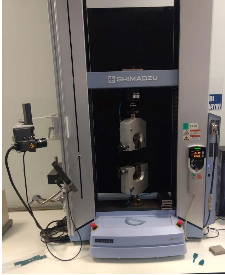
Şekil 3.39. Çekme deneyinin gerçekleştirildiği universal çekme cihazı
