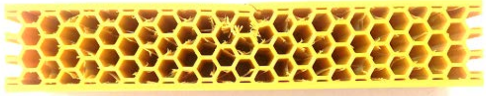
Şekil 4. 70. Altıgen balpeteği çekirdek geometrisine sahip sandviç yapının dinamik 3-nokta eğilme deneyi sonu hasar görünümü
