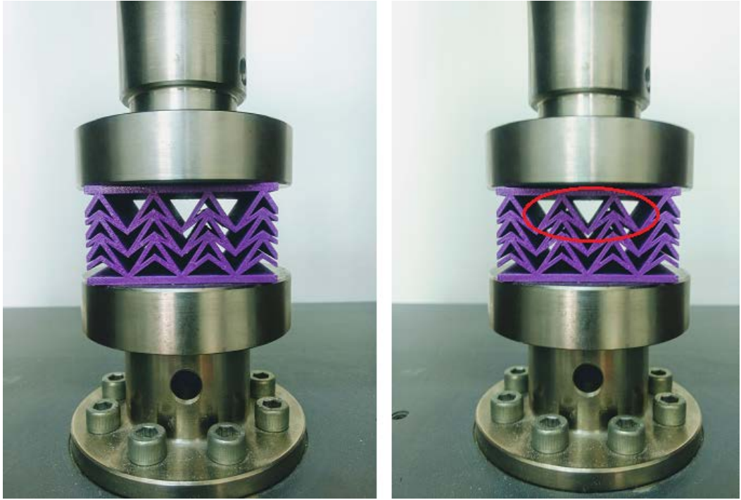
Şekil 4. 19. 3Boyutlu yazıcı ile üretilmiş çift ok kafa çekirdek geometrili sandviç yapıya ait bası deneyleri
