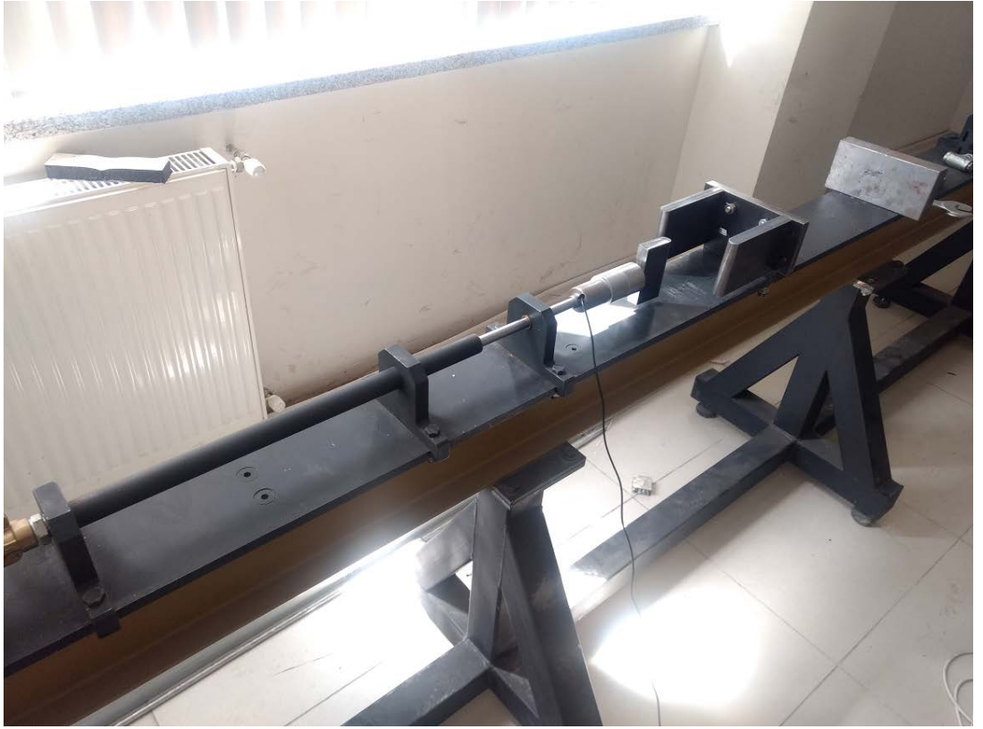
Şekil 3.45. SHB test düzeneğinden dönüştürülmüş dinamik 3-Nokta eğilme test düzeneği
