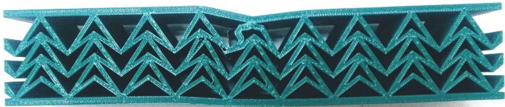
Şekil 4. 42. 3-Nokta eğme testi sonrası çift ok kafa çekirdeğe sahip sandviç yapıdaki hasar görünümü
