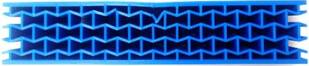
Şekil 4. 73. Yeniden kıvrımlı çekirdek geometrisine sahip sandviç yapının dinamik 3-nokta eğilme deneyi sonu hasar görünümü
