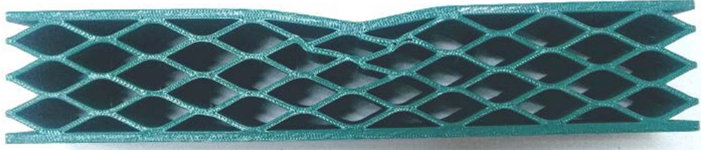
Şekil 4. 30. 3-Nokta eğme testi sonrası sinüzoidal oluklu çekirdeğe sahip sandviç yapıdaki hasar görünümü
