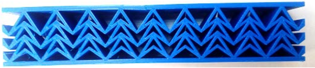
Şekil 4. 76. Çift ok kafa çekirdek geometrisine sahip sandviç yapının dinamik 3-nokta eğilme deneyi sonu hasar görünümü
