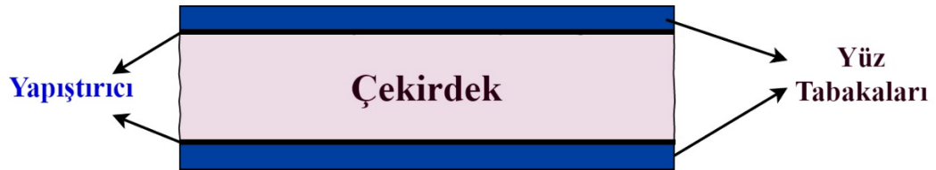
Şekil 2.42. Sandviç yapıyı oluşturan bileşenlerin şematik gösterimi
