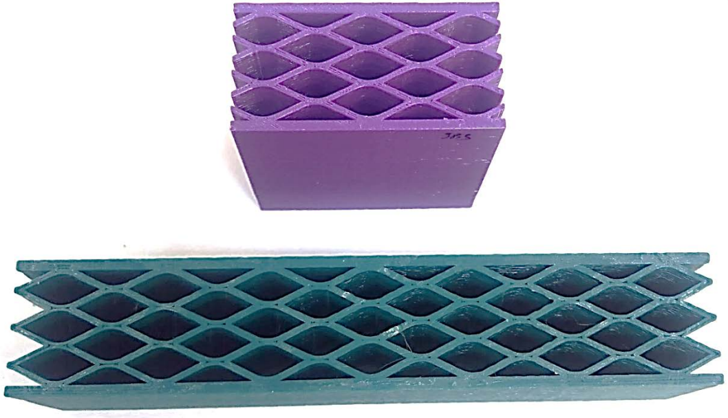
Şekil 3.34. 3Boyutlu yazıcıdan üretilmiş sinüzoidal oluklu çekirdek yapıya sahip sandviç test numuneleri
