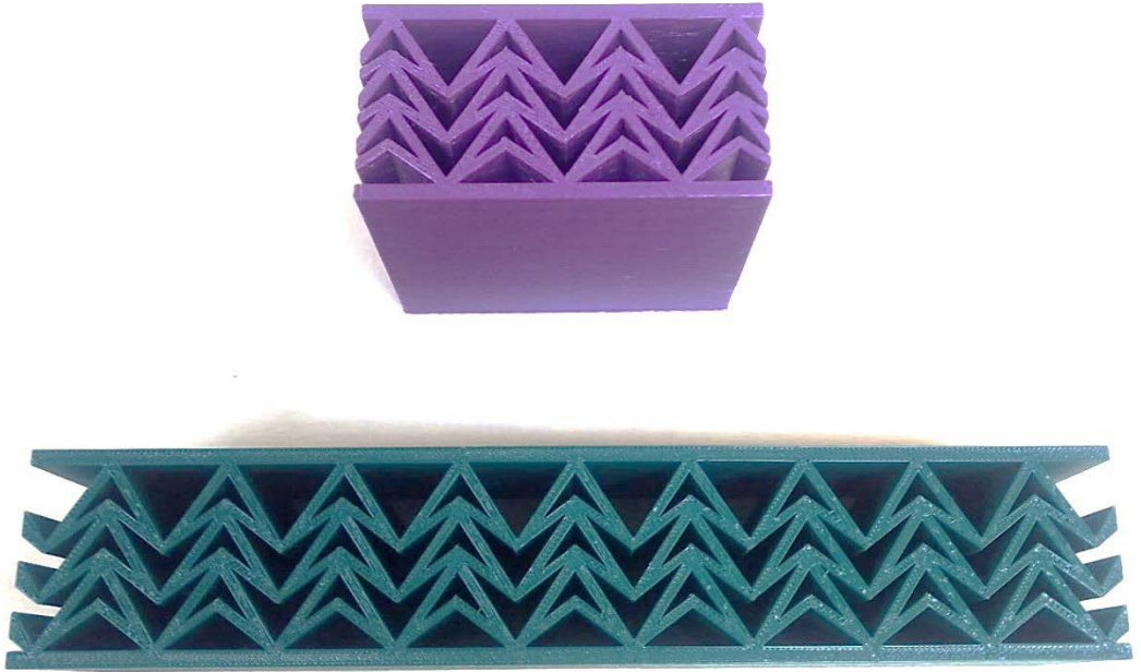
Şekil 3.37. 3Boyutlu yazıcıdan üretilmiş çift ok kafa çekirdek yapıya sahip sandviç test numuneleri
