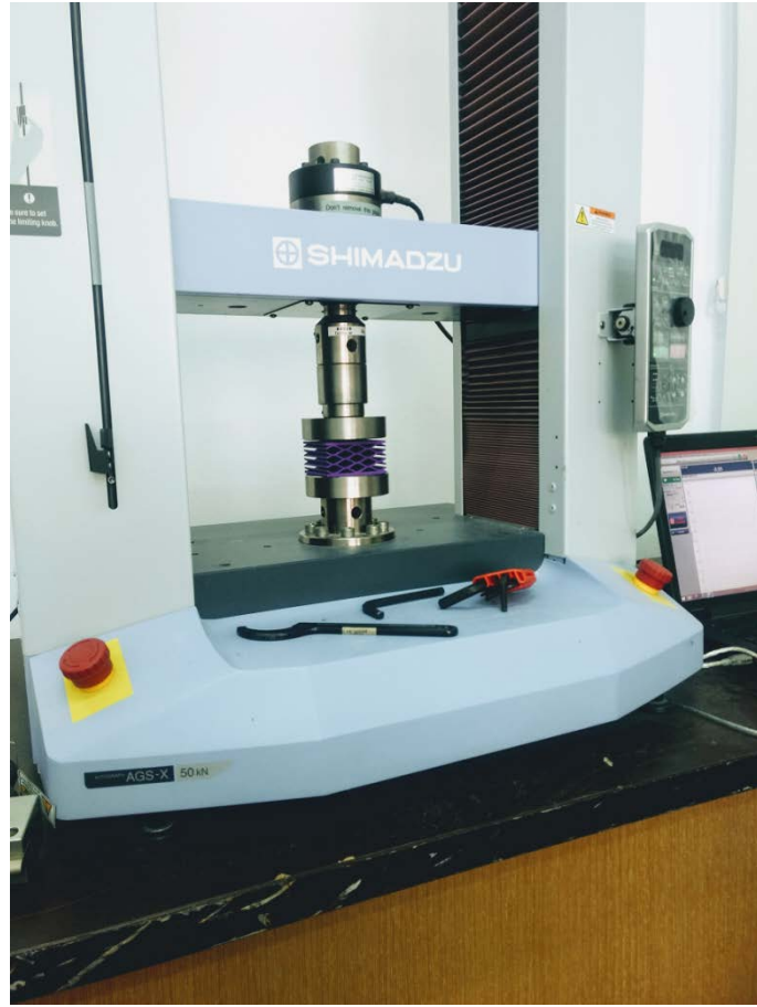
Şekil 3.41. Sandviç bası deneylerinin gerçekleştirildiği universal test cihazı
