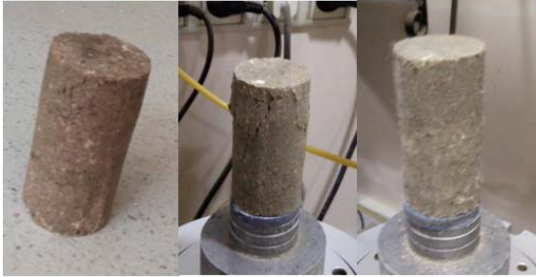
Şekil 4.12. Sırasıyla S, SC5 ve SPP1,0 numunelerin kırılma şekilleri
