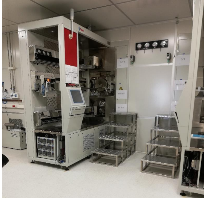
Şekil 3.2. SiO 2 tabakasının büyütülmesinde kullanılan difüzyon fırını
