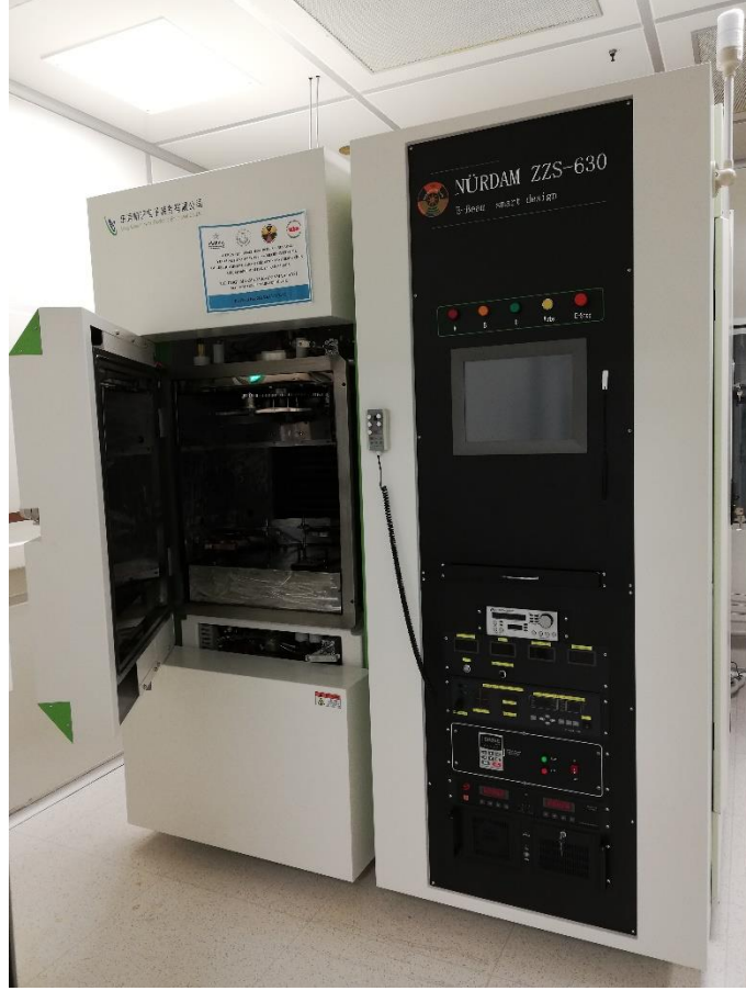
Şekil 3.4. \text{Yb}_2\text{O}_3 ince filminin büyütüldüğü EB-PVD sistemi
