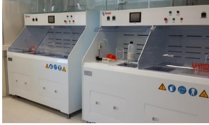
Şekil 3.1. Alttaşların temizlenmesi sırasında kullanılan ıslak tezgahlar
