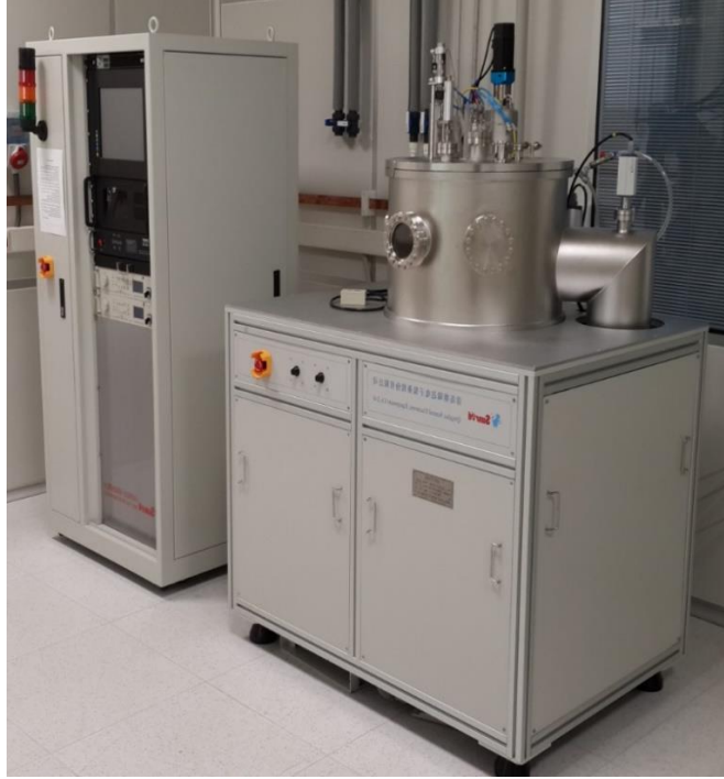
Şekil 3.6. Metal kontakların atıldığı RF/DC magnetron saçırma sistemi
