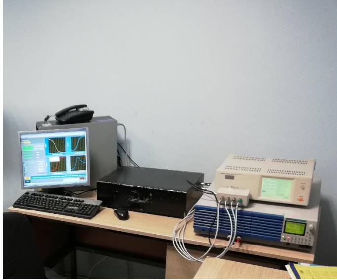
Şekil 3.7. MOS kapasitörlerin elektriksel karakteristiklerinin ölçüldüğü ölçüm düzeneği
