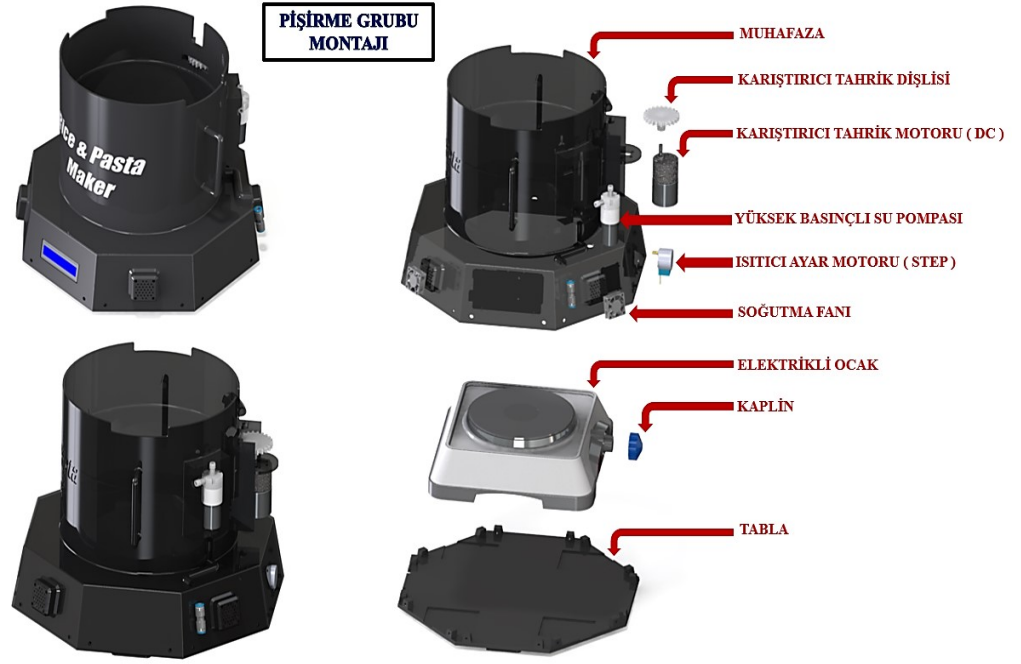
Şekil 3. 3. Cihazın pişirme grubu bileşenleri
