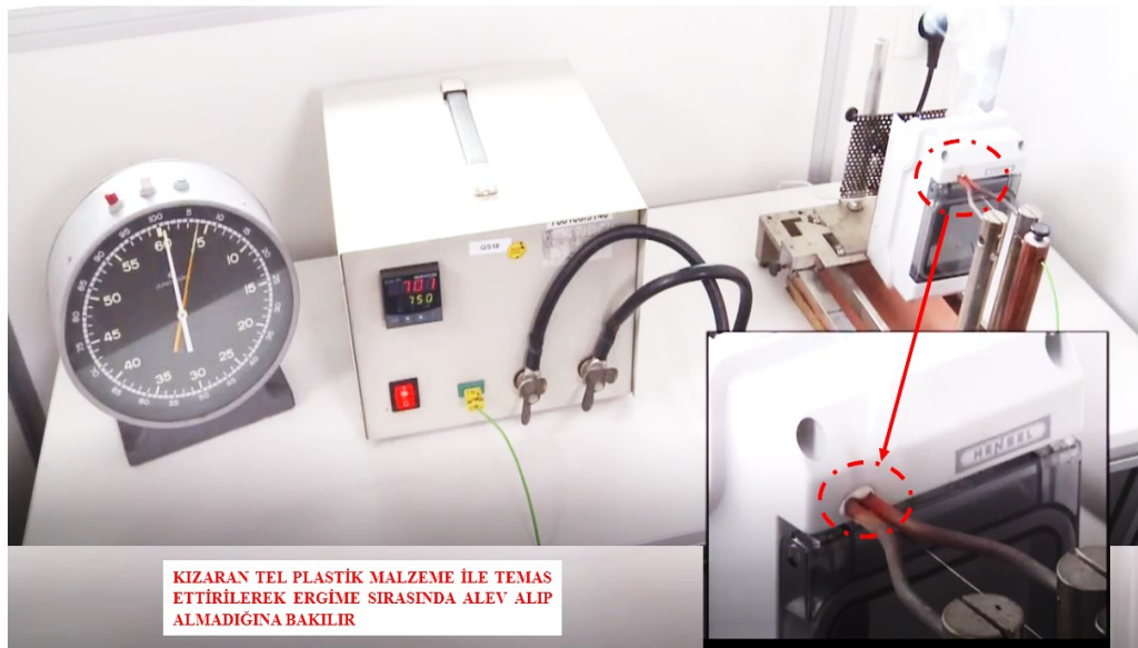
Şekil 4. 14. IEC 60695 Kızaran Tel Deneyi
