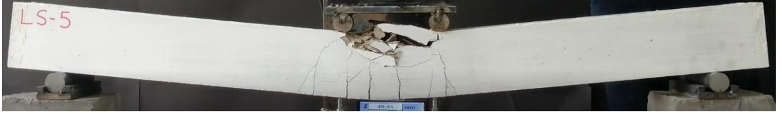
Şekil 4.29. LS-5 kirişinin deney sonundaki durumu
