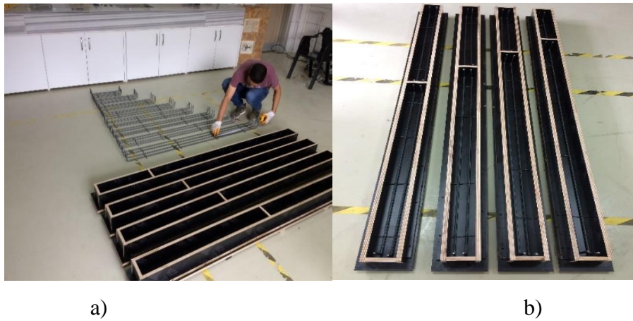
Şekil 3.5. a) Hazırlanmış olan kalıplar ve donatılar, b) Donatıların kalıpların içerisinde yerleşimi
