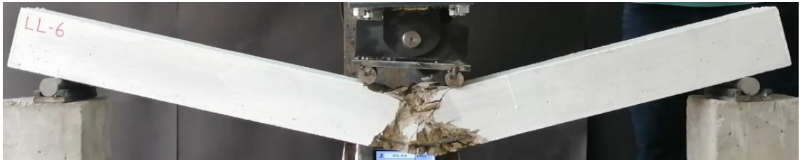
Şekil 4.92. LL-6 kirişinin deney sonundaki durumu
