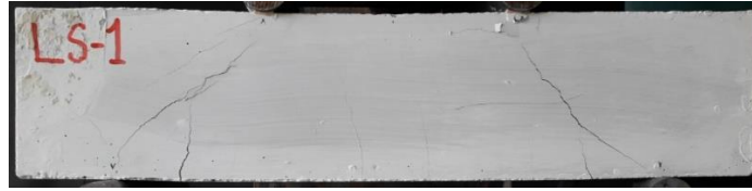
Şekil 4.3. LS-1 kirişinin maksimum yük altındaki durumu
