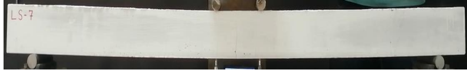
Şekil.4.41. LS-7 kirişinin akma anındaki durumu
