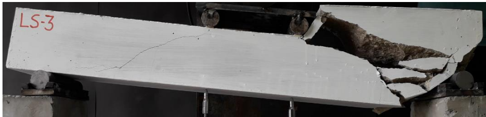
Şekil 4.16. LS-3 kirişinin deney sonundaki durumu
