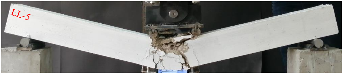
Şekil 4.85. LL-5 kirişinin deney sonundaki durumu
