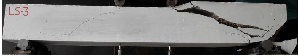
Şekil 4.15. LS-3 kirişinin maksimum yük altındaki durumu
