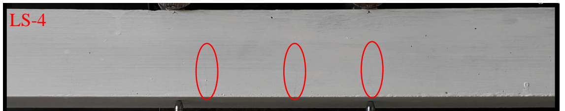
Şekil 4.20. LS-4 kirişinde oluşan ilk çatlaklar
