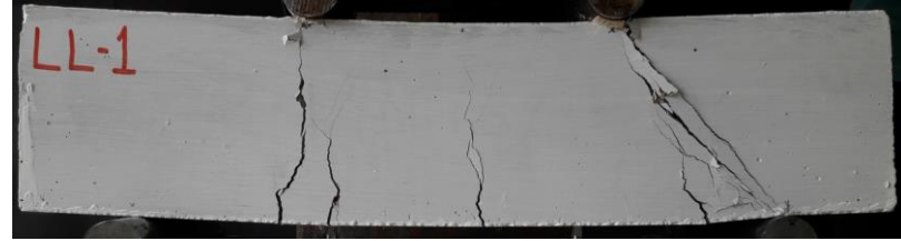
Şekil 4.56. LL-1 kirişinin maksimum yük altındaki durumu
