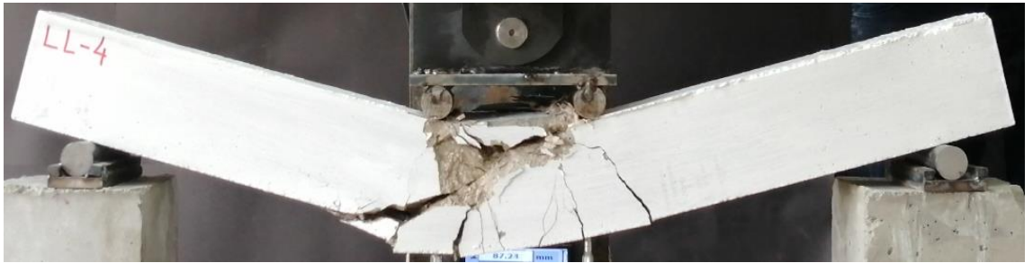
Şekil 4.78. LL-4 kirişinin deney sonundaki durumu
