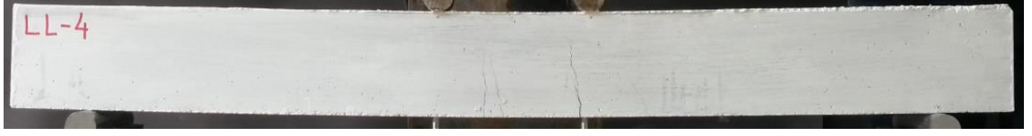
Şekil 4.76. LL-4 kirişinin akma anındaki durumu
