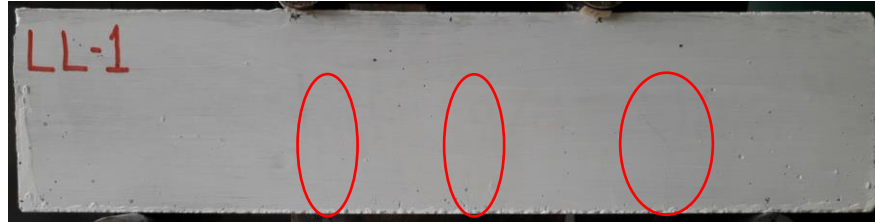
Şekil 4.54. LL-1 kirişinde oluşan ilk çatlaklar
