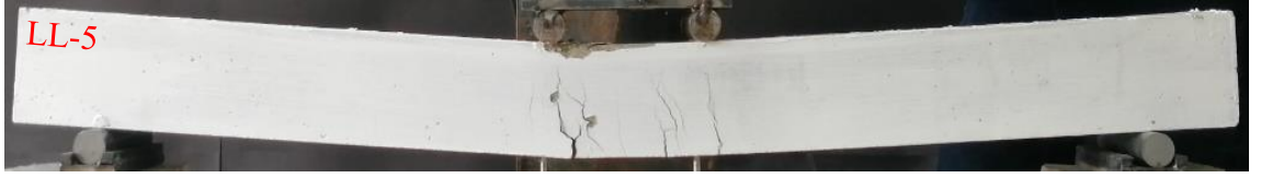
Şekil 4.84. LL-5 kirişinin maksimum yük altındaki durumu
