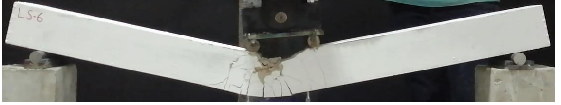
Şekil 4.36. LS-6 kirişinin deney sonundaki durumu
