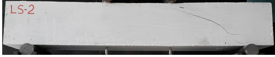
Şekil 4.9. LS-2 kirişinin maksimum yük altındaki durumu
