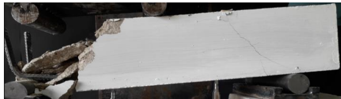
Şekil 4.4. LS-1 kirişinin deney sonundaki durumu
