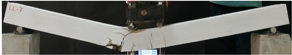
Şekil 4.99. LL-7 kirişinin deney sonundaki durumu
