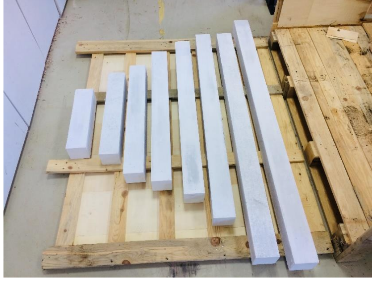
Şekil 3.9. Kür havuzundan çıkarılan kirişlerin boyanması
