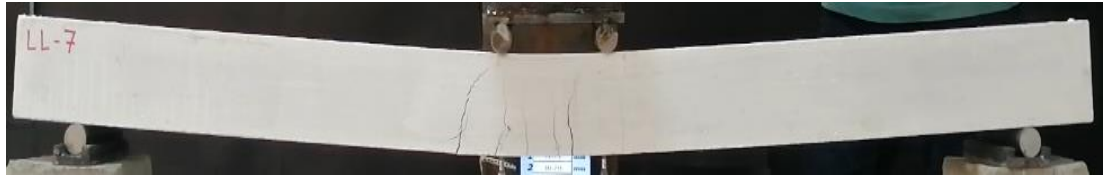
Şekil 4.98. LL-7 kirişinin maksimum yük altındaki durumu
