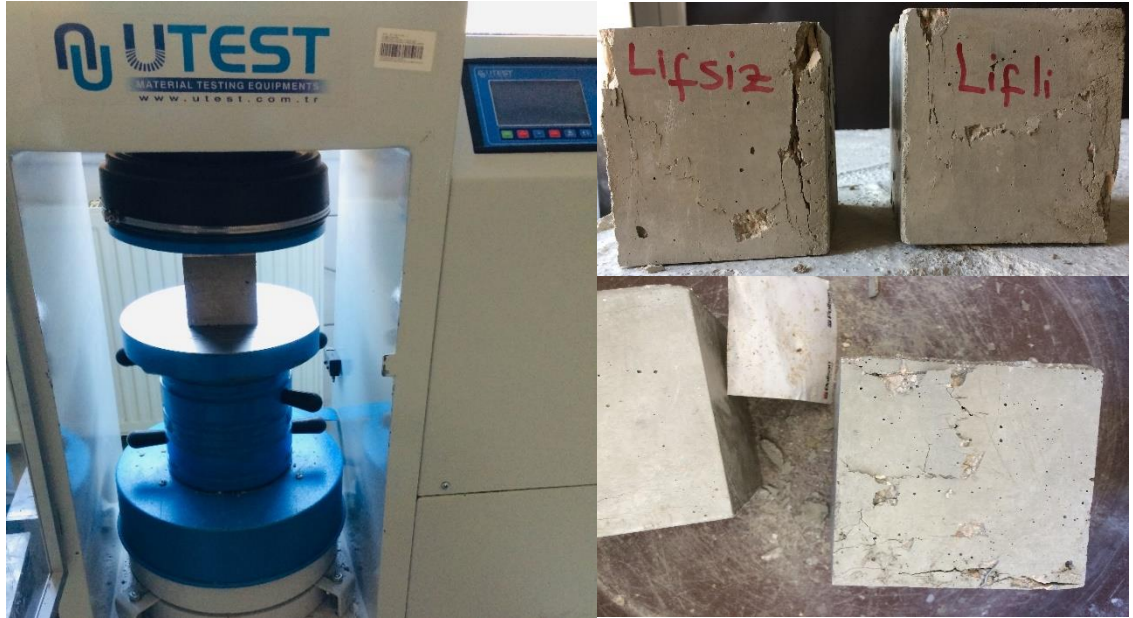
Şekil 3.10. Beton test presi ve test edilmiş küp numuneler
