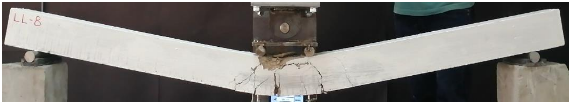
Şekil 4.106. LL-8 kirişinin deney sonundaki durumu
