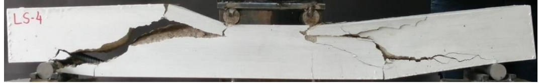
Şekil 4.22. LS-4 kirişinin deney sonundaki durumu
