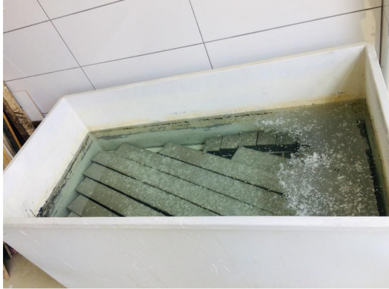
Şekil 3.8. Kür havuzunda kürlenen kirişler
