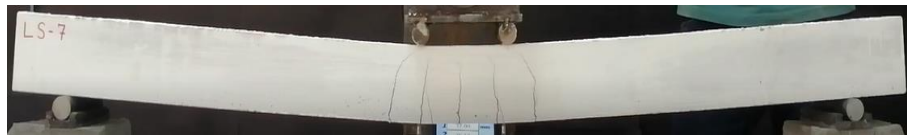
Şekil 4.42. LS-7 kirişinin maksimum yük altındaki durumu
