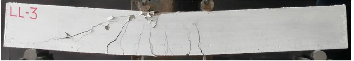
Şekil 4.70. LL-3 kirişinin maksimum yük altındaki durumu
