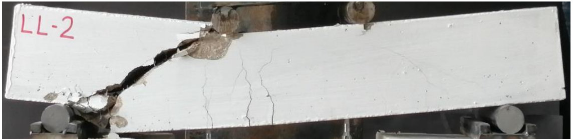
Şekil 4.64. LL-2 kirişinin deney sonundaki durumu
