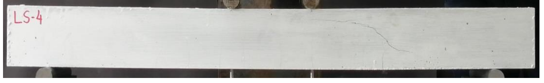
Şekil 4.21. LS-4 kirişinin maksimum yük altındaki durumu
