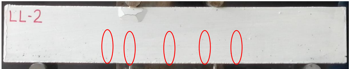
Şekil 4.61. LL-2 kirişinde oluşan ilk çatlaklar
