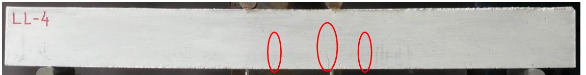
Şekil 4.75. LL-4 kirişinde oluşan ilk çatlaklar
