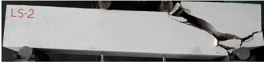
Şekil 4.10. LS-2 kirişinin deney sonundaki durumu
