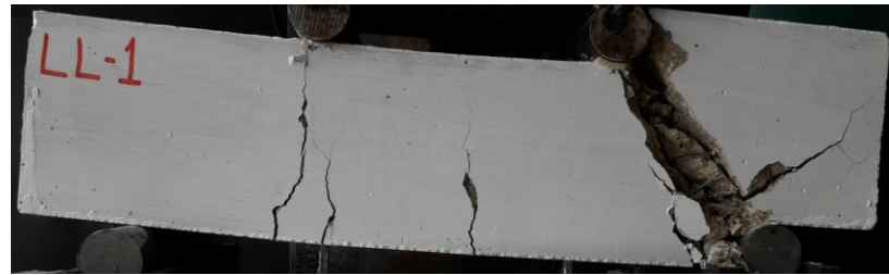
Şekil 4.57. LL-1 kirişinin deney sonundaki durumu
