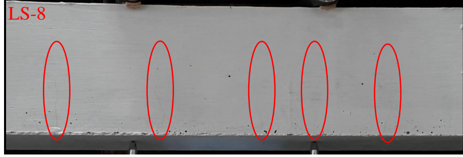
Şekil 4.47. LS-8 kirişinde oluşan ilk çatlaklar
