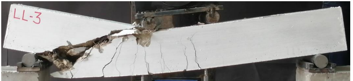
Şekil 4.71. LL-3 kirişinin deney sonundaki durumu
