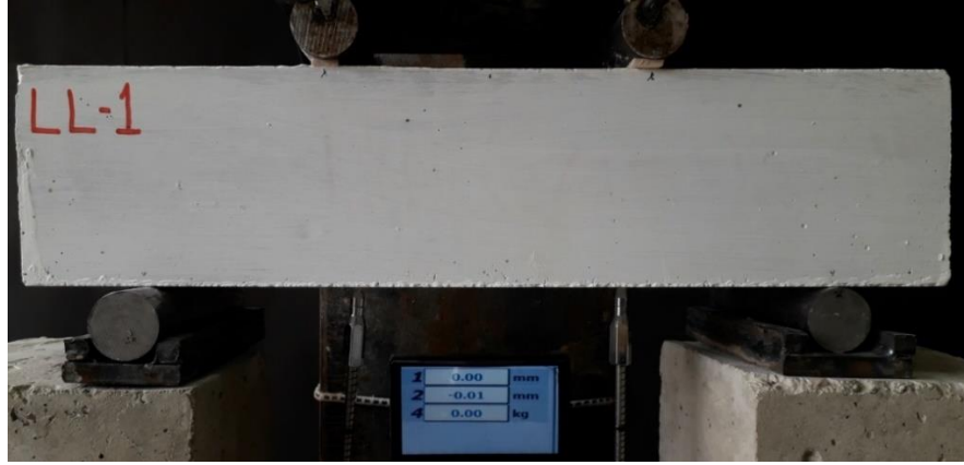
Şekil 4.53. LL-1 kirişinin test öncesi görüntüsü
