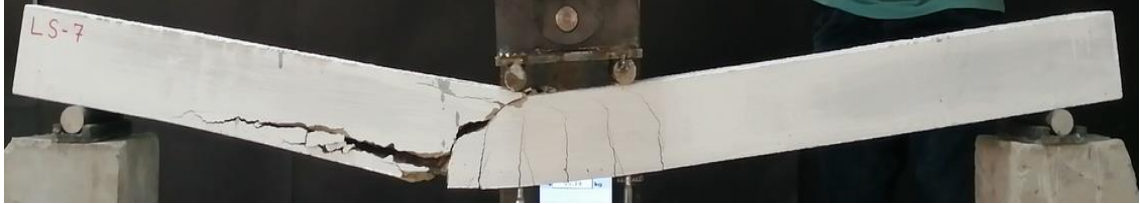
Şekil 4.43. LS-7 kirişinin deney sonundaki durumu
