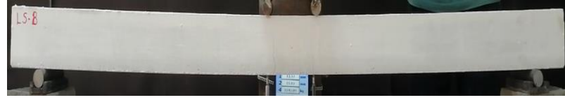
Şekil.4.48. LS-8 kirişinin akma anındaki durumu
