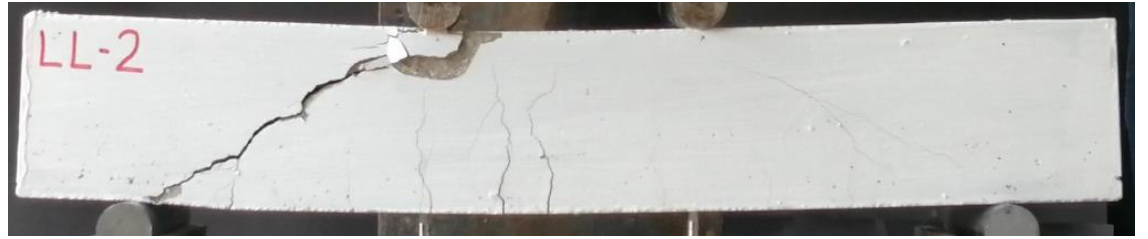
Şekil 4.63. LL-2 kirişinin maksimum yük altındaki durumu
