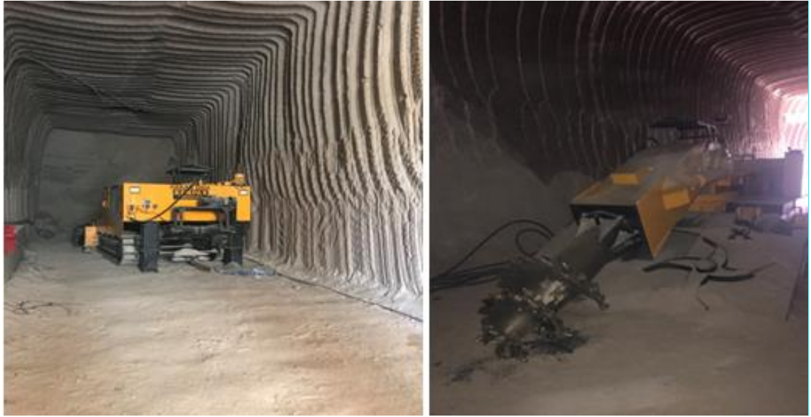
Şekil 1.6. Depo yapımında kullanılan makine (Zeynep TARIMCI'nın arşivinden alınmıştır).
