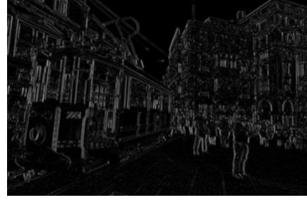
Şekil 3.73. Sobel Op. Uygulanmış Görüntü
