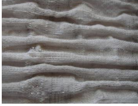
Şekil 2.8. Tek katlı, çift katlı ve dolgu atkısı kullanarak türetilmiş örgü yapısı ( Halaçeli 2009)
