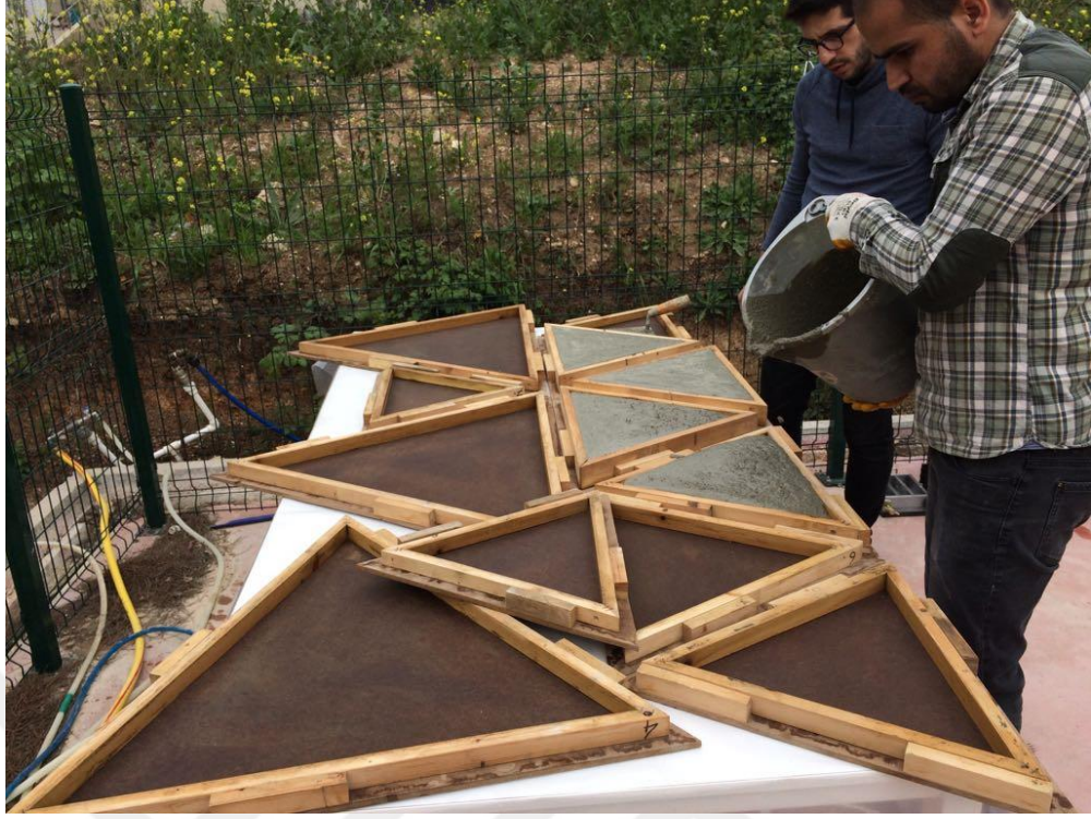
EK Şekil 3.3. Üçgen plaka numunelerin dökümü
