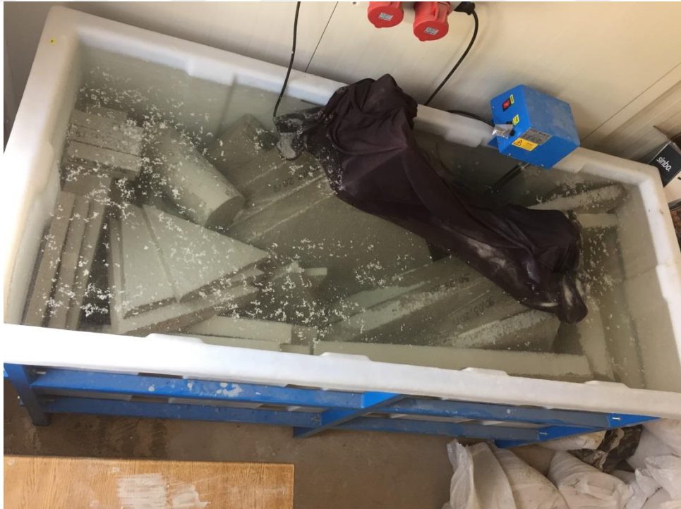
EK Şekil 3.10. Numuneler 28 gün kür havuzunda beklemede
