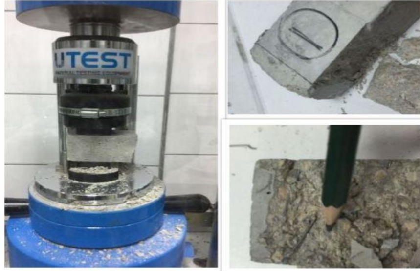
Şekil 3.5. Standart küp basınç deney yapılışını göstermektedir
