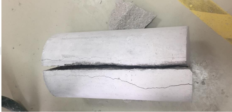
Şekil 3.7. S/C oranı 0.62 lifsiz standart silindir yarmada çekme deney kırılmış durumu göstermektedir
