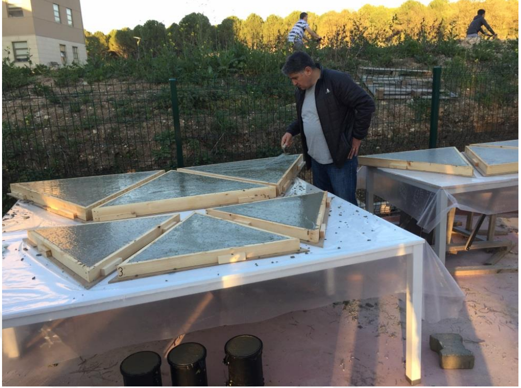
EK Şekil 3.5. Üçgen plaka numunelerin döküm sırasında hocanın kontrolü
