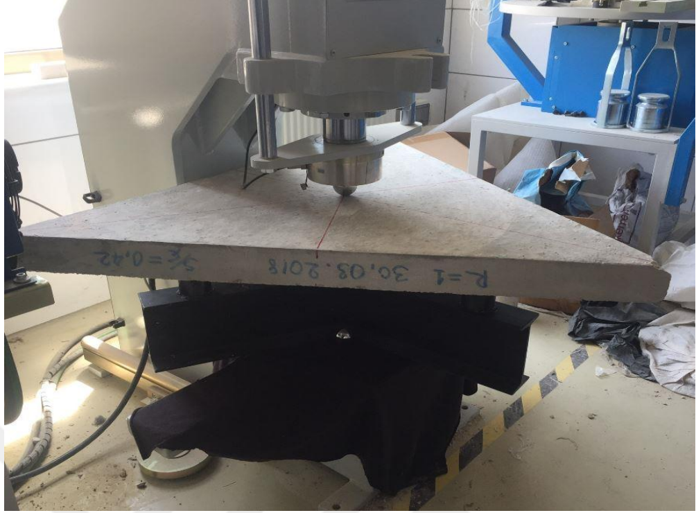
EK Şekil 3.13. T_042LS_R11 nolu üçgen numunenin yükleme aşaması
