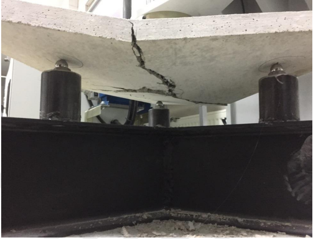
EK Şekil 3.15. T_042LL_R43 nolu üçgen numunenin yükleme aşaması
