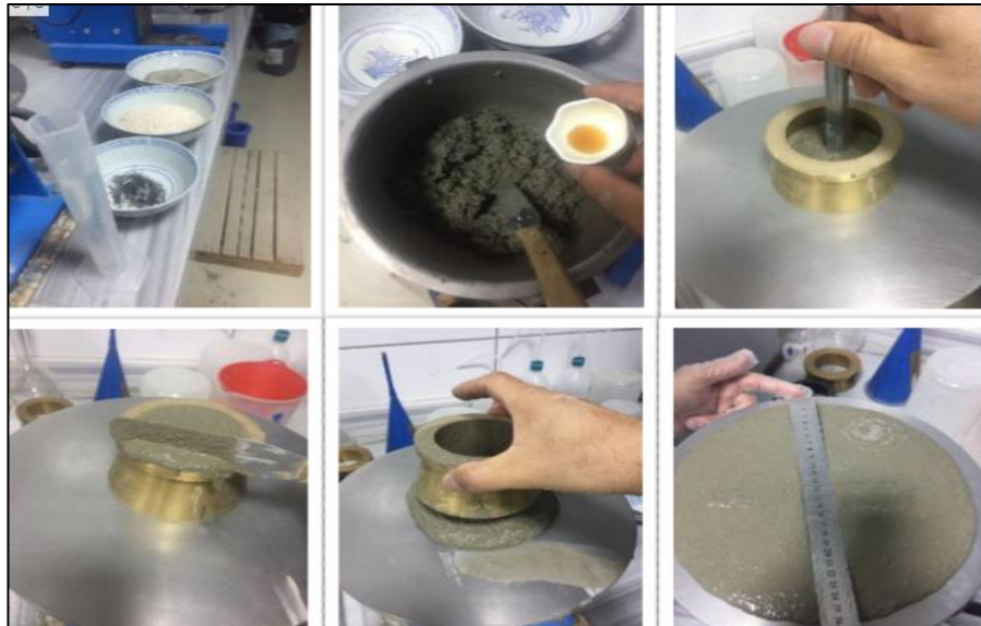
Şekil 3.1. Karışımlar için yayılma deneyi yapılışı göstermektedir
