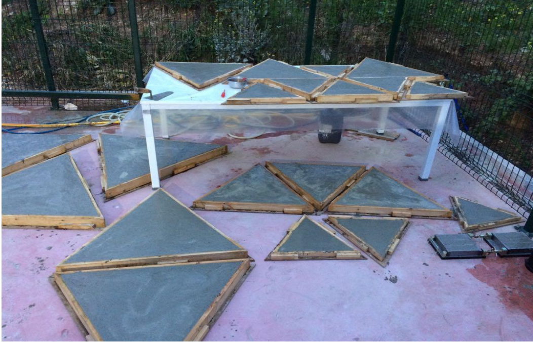
EK Şekil 3.4. Üçgen plaka numuneleri üretim aşamasında
