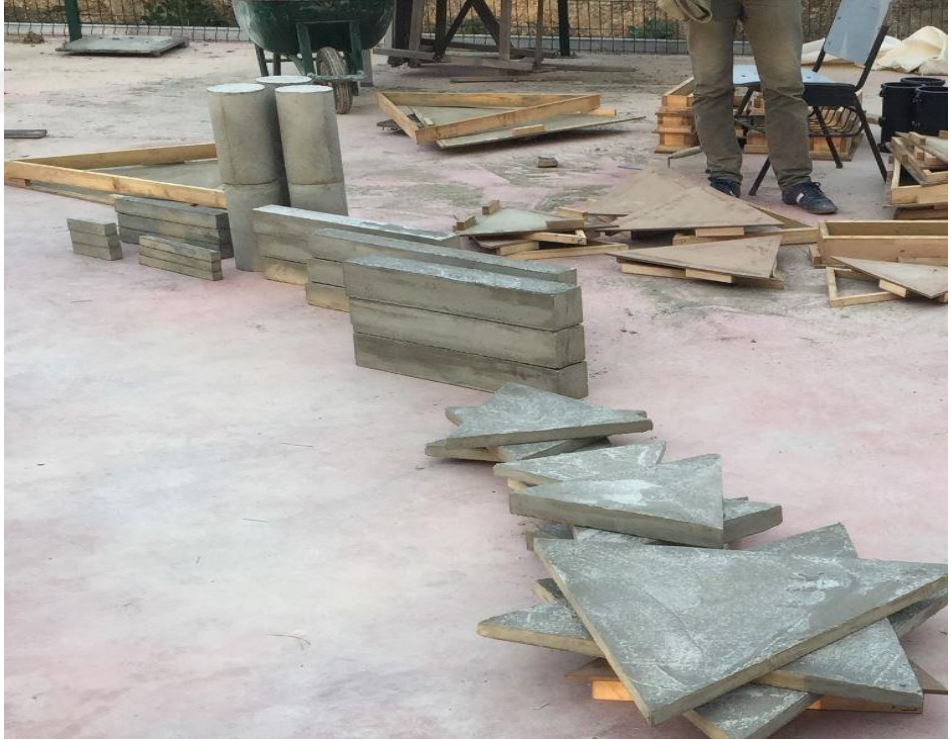
EK Şekil 3.8. Numuneleri kalıplardan çıkartma aşamaları
