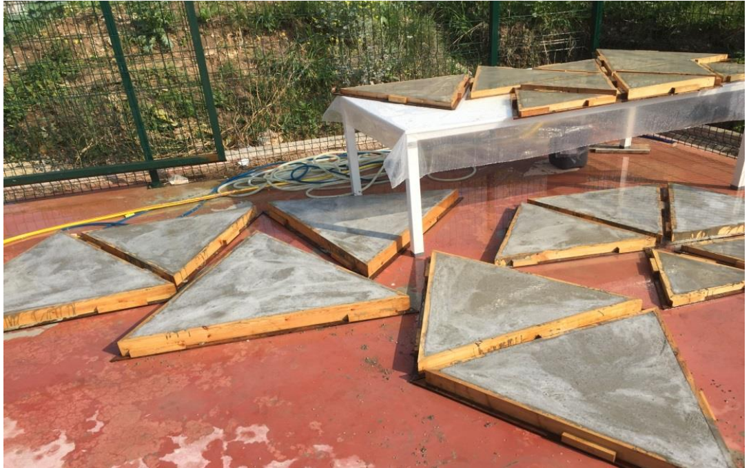
EK Şekil 3.5. Üçgen plaka numuneleri 12 saat sonra kürlenme durumu
