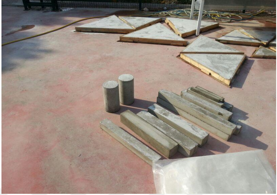
EK Şekil 3.7. Numuneleri kalıplardan çıkartma aşamaları
