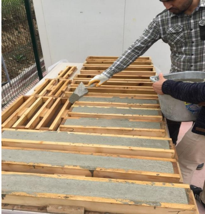
EK Şekil 3.2. kiriş numunelerin dökümü
