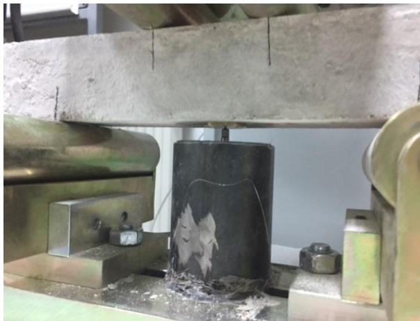
řekil 3.13. Kiriř elemanında LVDT yerleřtirmesini gsterimi
