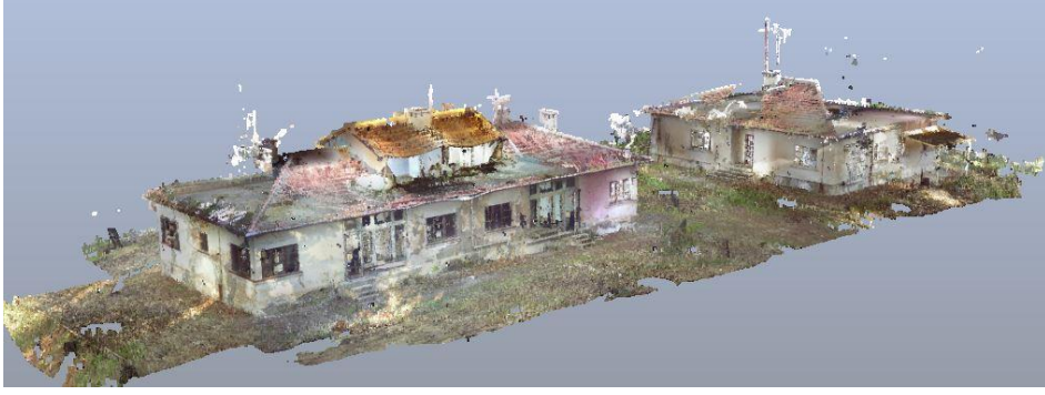
EK 1 3b nokta bulutu verilerinin elde edilmesi, Faro Focus 3D S 120 lazer taramaları
