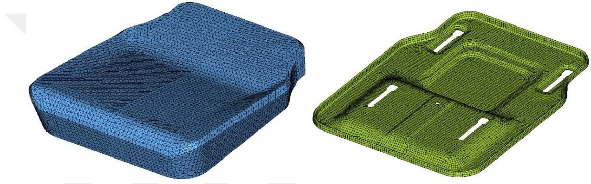
Şekil 4.22. Oturak süngeri ve oturak sacına ait sonlu elemanlar modeli
