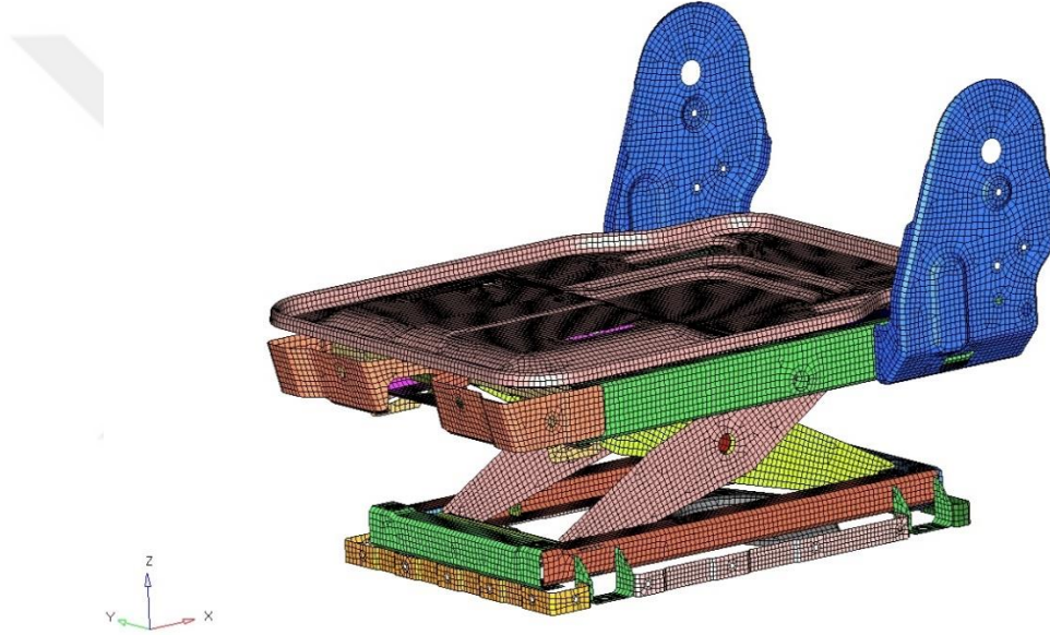
Şekil 3.12. Hypermesh programında ağ örülmüş model
