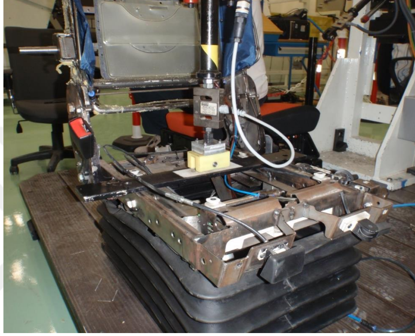
Şekil 4.25. Oturak iskeleti yarı kompleksi basma testi düzeneği
